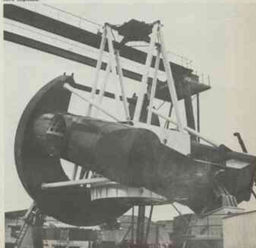
Fig. 4 - le télescope monté, et prêt pour les essais en usine, à la Rochelle-Pallice. L'anneau de site est rempli par un contre-poids provisoire. Une barre brisant le fer à cheval n'est pas encore déposée.
