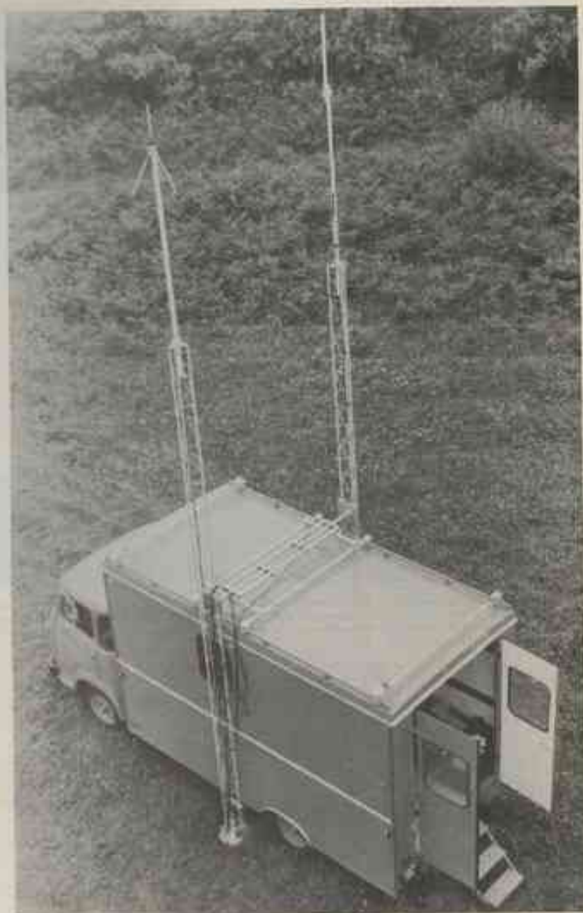
Fig. 7 – Le sondage différentiel en opération dans les Pyrénées orientales. L'utilisation de liaison radio VHF impose à la station réceptrice d'être en vue directe de toutes les stations d'émission, ce qui conduit à l'installer dans des sites élevés parfois difficilement accessibles.
