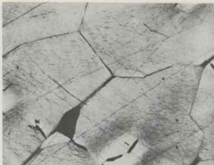
Film épitaxial de TGSa sur TGS semi-métallisé. Les dimensions des cristaux sont de l'ordre de 150\mu\text{m} .
