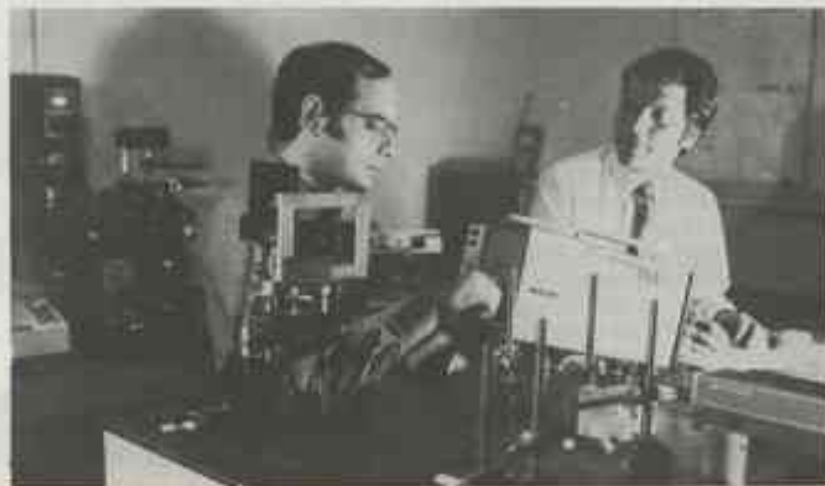
Mesure de l'efficacité de diffraction d'un hologramme.
