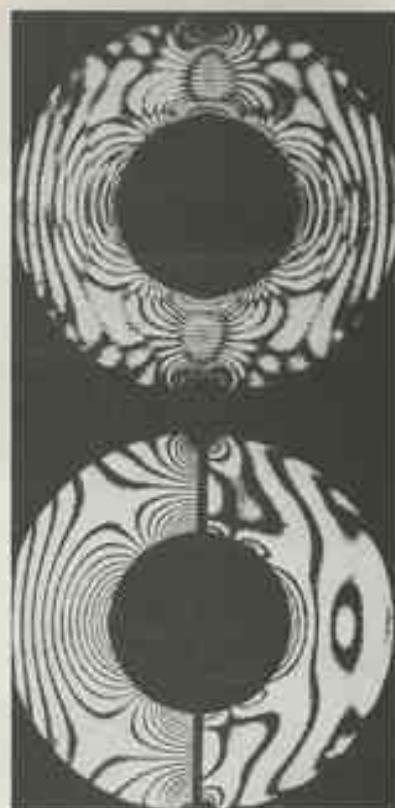
Fig. 4 - Les biréfringences qui prennent naissance à l'intérieur d'une maquette plastique soumise à des forces, s'accompagnent de variations d'épaisseur. Une holographie de l'objet éclairé en lumière non polarisée permet l'enregistrement d'un hologramme « double », correspondant aux deux composantes perpendiculaires de la lumière incidente. On détermine ainsi les isochromes, caractérisant la différence des contraintes principales. Au même temps, sur la même plaque, suivant un autre plan d'incidence, on enregistre un hologramme en double exposition, le premier ayant été effectué avant la mise en charge. La restitution montre alors la superposition d'une deuxième famille de franges, les isoplethes, caractérisant la somme des contraintes principales. L'ensemble est difficilement exploitable (a). Cependant, si l'on élimine les isochromes suivant l'un des canaux, l'hologramme éclairé en lumière blanche restitue simultanément les isochromes et les isoplethes dans les deux directions choisies pour l'enregistrement, réalisant la séparation des contraintes principales: en (b) à gauche sont reproduites les isoplethes, à droite les isochromes. Cliquez LOGO.
