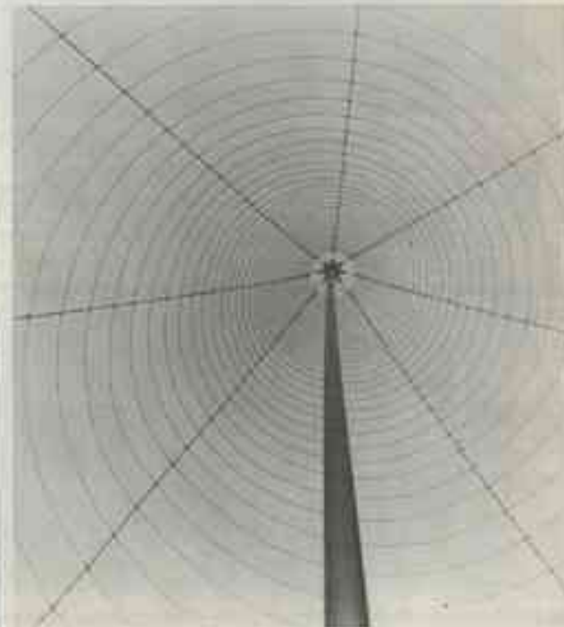
Fig. 6 - Une hélice vue du centre. Huit fils conducteurs partent du sommet. Leur connexion au câble coaxial de descente d'antenne se fait par l'intermédiaire de diodes placées au sommet des mâts et télécommandées par un ordinateur.
