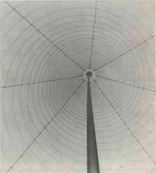
Fig. 6 - Une hélice vue du centre. Huit fils conducteurs partent du sommet. Leur connexion au câble coaxial de descente d'antenne se fait par l'intermédiaire de diodes placées au sommet des mât et désamorcées par un ordinateur.
