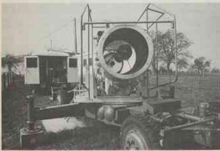
Opération lutte contre la pollution. Le Lidar (association d'un laser et d'un radar) permet de déterminer la forme et la position d'un pommeau de fumée. Photo M. Gréde - EDF-BDDEL
