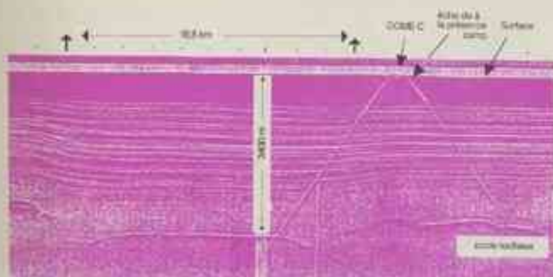
Fig. 2 - Coupe de la glace obtenue par sondage aérien radiométrique à partir d'un instrument Scott Polar Research Institute. Au Dôme C l'épaisseur de la glace est de 3 400 m. Les niveaux qui apparaissent sont dus à des réflexions dont la cause est pour l'instant inconnue. On pense qu'ils représentent des couches de glace de même âge. La régularité de ces niveaux dans les couches supérieures est un indice qu'ils ne sont pas perturbés par l'écoulement de la glace. Le cône qui affleure au site du Dôme C est un écho parasite dû à la présence du camp de forage.
