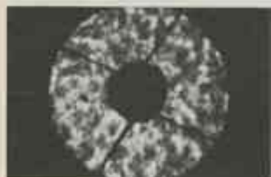
Photographie de l'éclairement aléatoire de la pupille du télescope de 1,52 m de l'Observatoire de Haute-Provence lorsqu'on vise une étoile. Les « ombres volantes » ont été figées par une pose de 1 ms. Le croissant central correspond à l'obscuration du miroir secondaire. (ERA 669).
