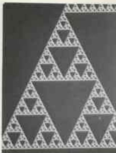
Niveau fractal de filaments submicroniques d'aluminium. Taille de Sierpinski ( T \approx 10^{-4} cm). À l'échelle de la supraconductivité d'un tel objet fractal constitue une "petite" "face" fixe, due à une fructueuse collaboration entre le CNET-Meylan et le CNRS-CRTBT, Grenoble. Photo CNET.
