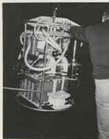
Mise en œuvre, au cours de la campagne Ficecarn 1985 (voir résultats marquants), à bord du R/O "Le Surp", d'un instrument de haute technologie pour l'étude de la matière en suspension dans l'océan. Cet ensemble dénommé POP (Particules Océan Profondes) permet la filtration par pompage de grands volumes d'eau de mer jusqu'à 1 000 mètres de profondeur (filtrations séquentielles sur quatre vélos commandées à bord du navire : environ 1 m³/h ; 4 heures d'autonomie).
