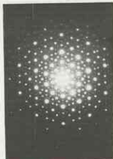
Diagramme de diffraction électronique de l'alliage Al-Mn selon l'axe pentagonal ou la symétrie d'ordre 5 apparaît. © CNRS - photo R. Farber.
