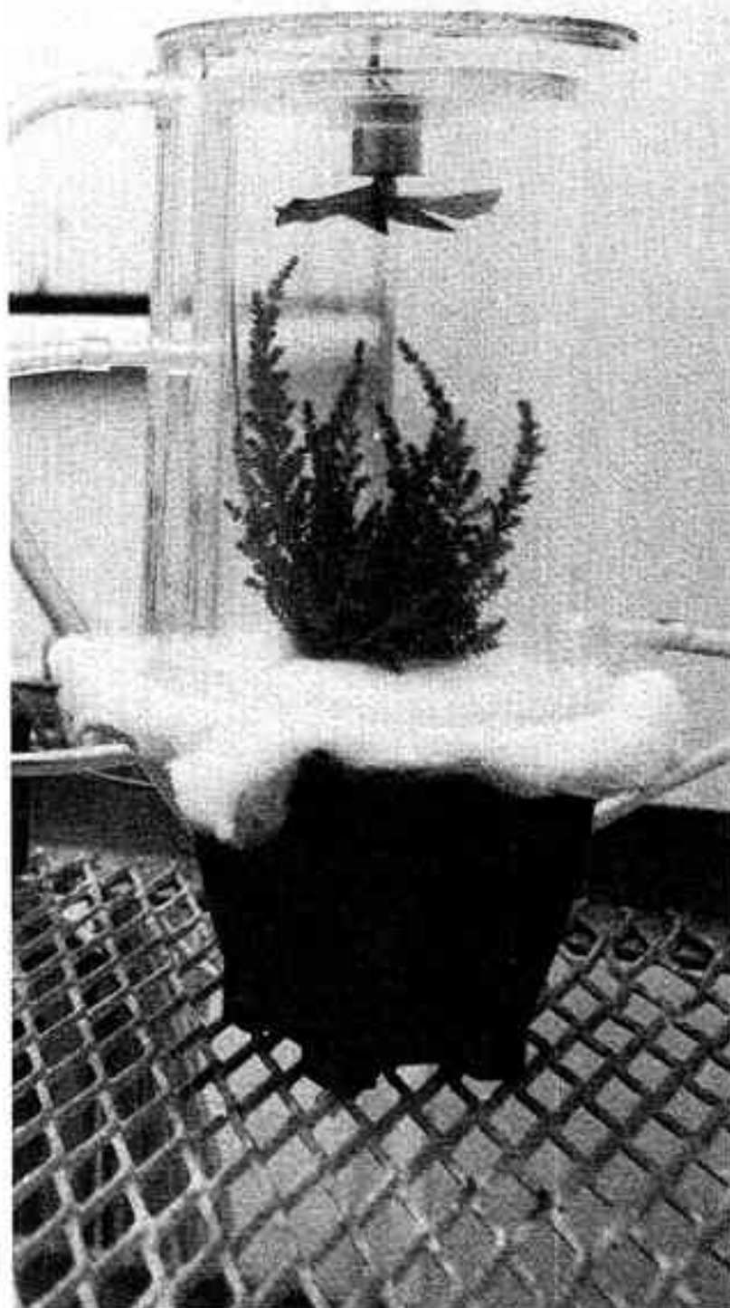
Mesure, en conditions contrôlées d'environnement, des échanges de gaz carbonique d'un pied de Calluna asséchée. (Phytotron - Gif-sur-Yvette).
