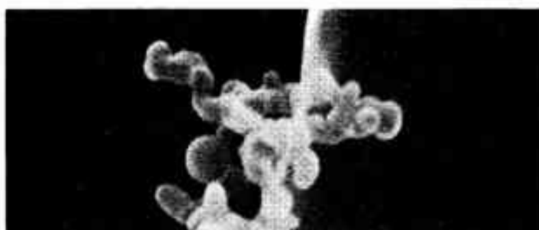
Fig. 2 - a) Partie attaquée par l'eau d'un grain de silicate tricalcique, b) Partie du grain ayant résisté à l'attaque après 15 minutes. (LA 23 - Dijon).
