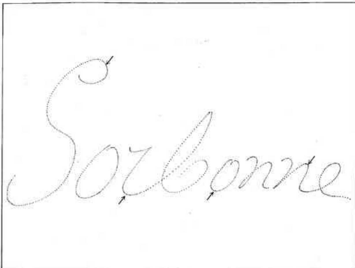
Fig. 4 – Premiers enregistrements dynamiques de l'écriture. – Dès 1890 Binet et son collaborateur Courtier, essayaient d'enregistrer la vitesse du geste graphique à l'aide du crayon électrique de Edison, qui perforait le papier environ 200 fois par seconde. La distance entre chaque point représente la trajectoire parcourue en 5 msec et permet d'évaluer la vitesse tangentielle moyenne du geste dans cet intervalle. On peut constater, qualitativement, qu'il existe une relation entre la courbure de la trajectoire et la vitesse tangentielle. On voit en particulier que la vitesse décroît considérablement lorsque le tracé est très courbé. Le tracé figuré a été redessiné à partir des données originales de Binet, conservées dans les archives du Laboratoire de psychologie de Paris V. Nous remercions Mme G. Oléron qui nous a permis de reproduire ces données.
