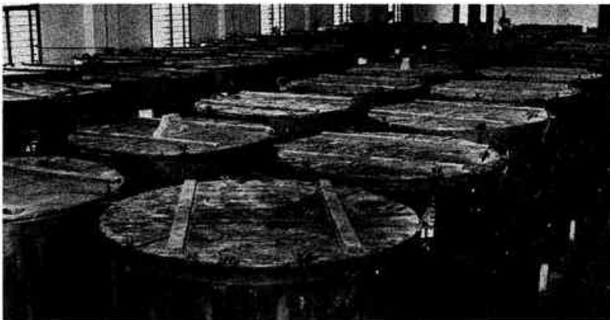
Préparations âyurvédiques en série : tonneaux de fermentation pour les boissons alcoolisées à base de plantes médicinales (The Indian medical practioners' co-operative pharmacy, Madras.)
