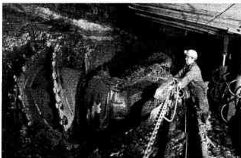
Haveuse Anderson simple tambour dans une taille à soutènement marchant Ferronstatik au siège de Folschviller. Photo Gilbert Friderich. (Cliché Charbonnage de France).
