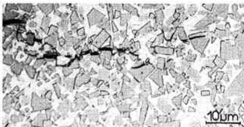
La résistance des matériaux composites à la propagation des fissures constitue l'un de leurs atouts essentiels. La partie gauche de la micrographie met en évidence la propagation d'une fissure dans un composite de cobalt et de carbure de tungstène. Echelle : 1,5 cm = 10 µm (Laboratoire de cristallographie et chimie du solide, LA 251).
