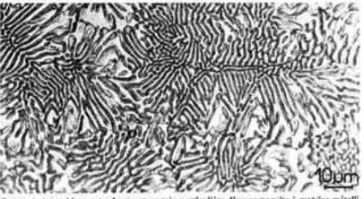
Cette micrographie montre la structure très particulière d'un composite à matrice métallique, un estectique de molybdène et de nickel obtenu par fusion aux hyperfréquences. Sur le cliché :  $0.8~{\rm cm}=10_{\mu}$  m (Laboratoire de cristallographie et chimie du solide, LA 251).
