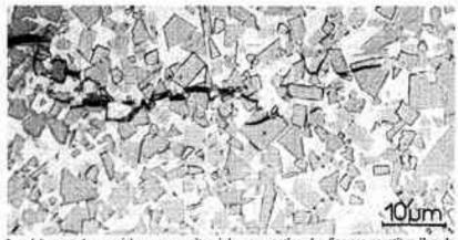
La résistance des matériaux composites à la propagation des fissures constitue l'un de leurs atouts essentiels. La partie grache de la micrographie met en évidence la propagation d'une fissure dans un composite de cobalt et de carbure de tangstène. Echelle : 1,5 cm = 10<sub>11</sub> m (Laboratoire de cristallographie et chimie du solide, LA 251).
