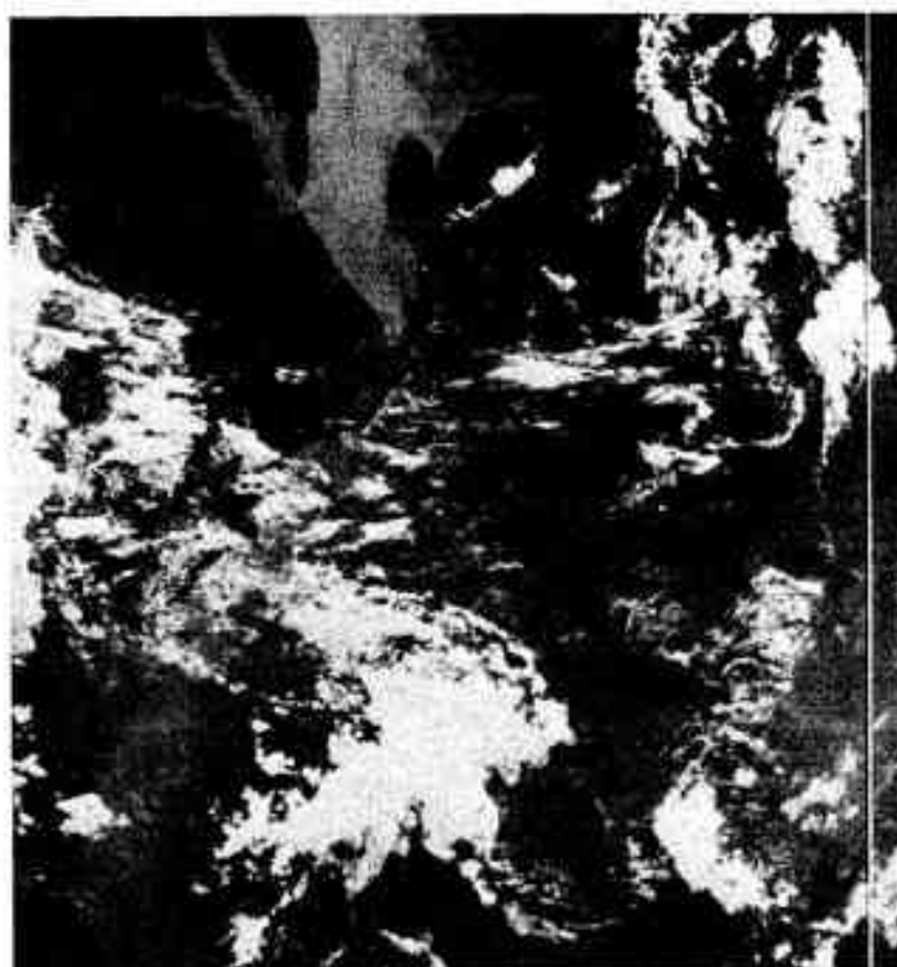
Fig. 1 - Télédétection, par radiométrie infrarouge depuis satellite, de la température de surface de l'océan, dans la région du Gulf Stream, au large de la côte Est des Etats-Unis. Les zones sombres (chaudes) en bordure des zones claires (froides) indiquent des méandres anticycloniques qui se referment en anneaux emprisonnant des masses d'eaux chaudes. Image prise le 1er mai 1977 (14 h 28 GMT) par le radiomètre à très haute résolution (VHRR) du satellite NOAA 5. (Extrait de : « Oceanic and related atmospheric phenomena as viewed from environmental satellites » - NOAA - US Dpt of Commerce, Office of oceanic and atmospheric services, Washington, DC, avril 79, p. 5).
