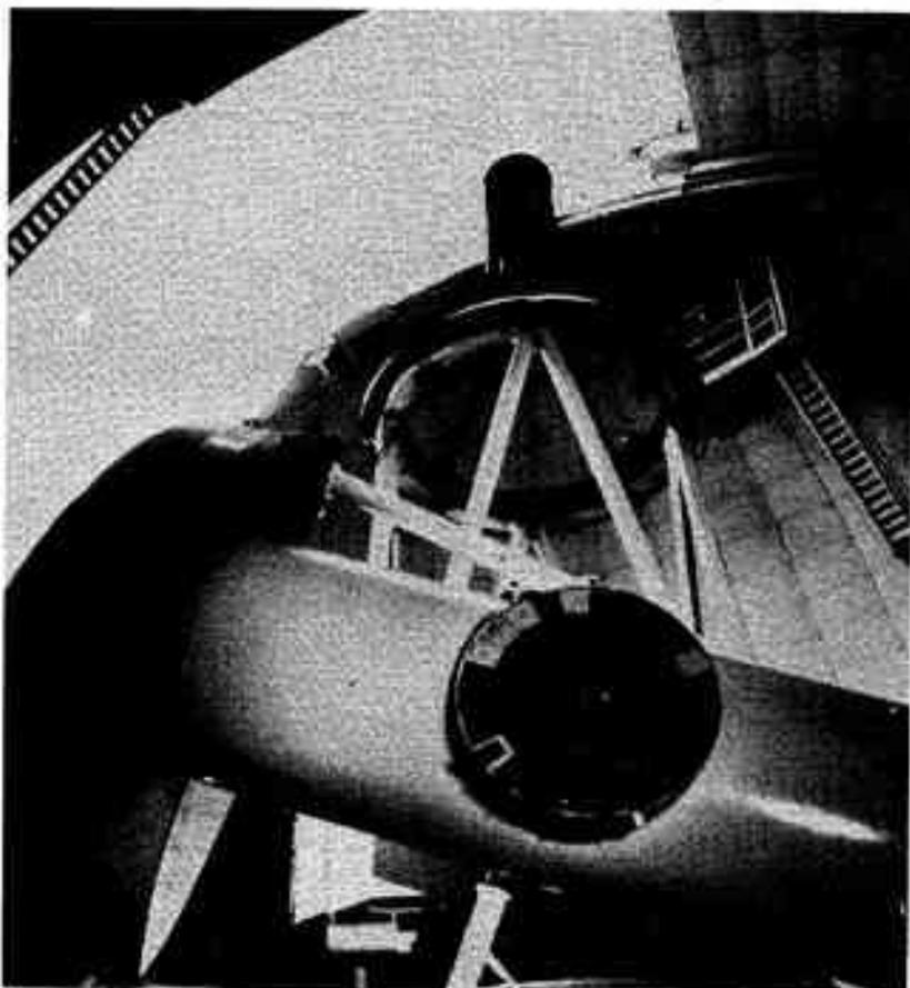
Fig. 1 - Photographie récente du télescope Canada-France-Hawaii, dans sa configuration - foyer primaire (photo CFHT).
