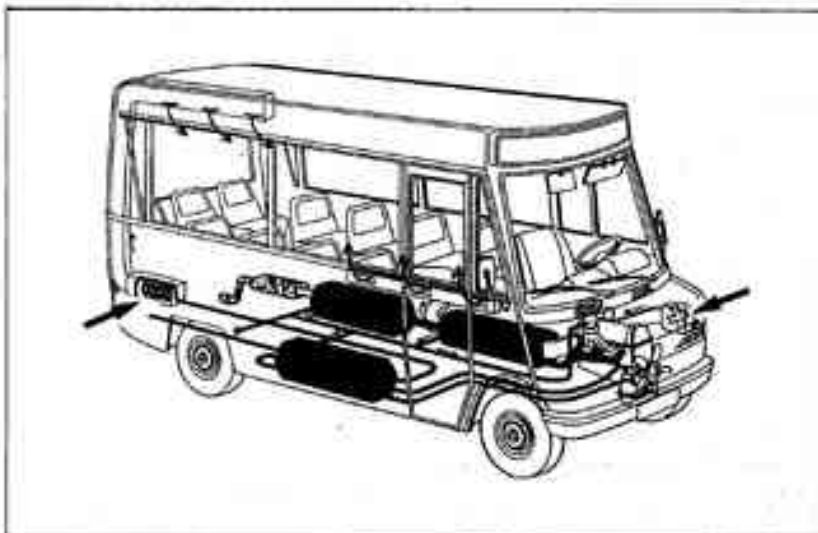
Fig. 4 - Minibus Daimler-Benz alimenté en hydrogène. Le réservoir situé juste derrière le moteur contient l'hydrure de magnésium, il est ainsi chauffé par les gaz d'échappement qui vont ensuite vers les réservoirs situés en aval et contenant de l'hydrure de fer-titane ; le troisième réservoir (fer-titane) sert à la climatisation.
