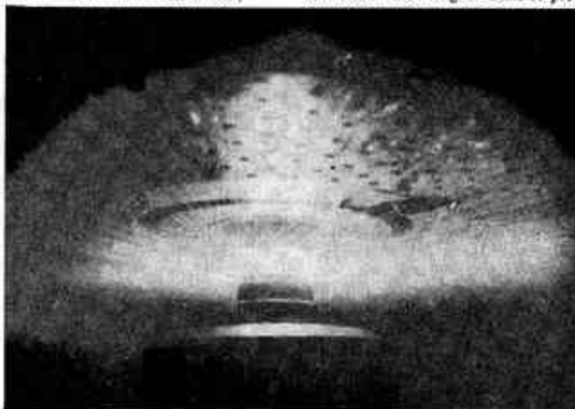
Obtention de poudres microcristallines hypertrempées par refroidissement rapide de gouttes dans un jet de gaz froid. Ces gouttes résultent d'une pulvérisation du métal liquide par un disque en rotation. (Machine de Pratt et Whitney Aircraft Corporation Etats-Unis).
