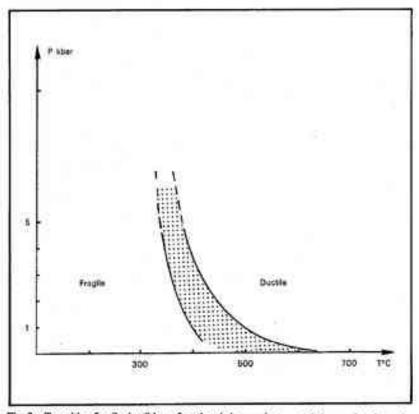
Fig. 2 - Transition fragile-ductible en fonction de la température et de la pression de confinement, déterminée expérimentalement sur des échantillens de diabase (roche microgrenue de composition basaitique). (D'après Y. Caristan, 1982).
