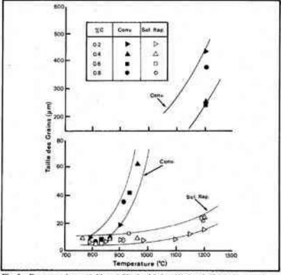
Fig. 5 – Dans un acier austénitique à 9% de nickel et 4% de cobalí, la taille des cristaux est beaucoup moins modifiée par un traitement thermique (1 heure à différentes températures) lorsque l'alliage résulte d'un procédé de solidification rapide.
