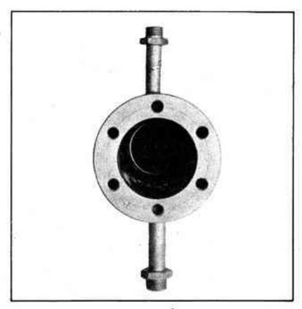
Fig. 4 - Echantilion métallique émaillé par du verre fluoré. Seules les parois internes du réacteur sont recouvertes de verre fluoré.
