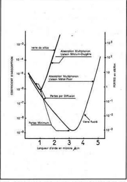
Fig. 2 – Diagramme montrant l'évolution de l'absorption intrinsèque de la lumière et des pertes par absorption en dB/km en fonction de la longueur d'onde pour des verres idéalement purs. 1 – verres de silice ; 2 – verres fluorés. Le minimum est beaucoup plus bas pour les verres fluorés.
