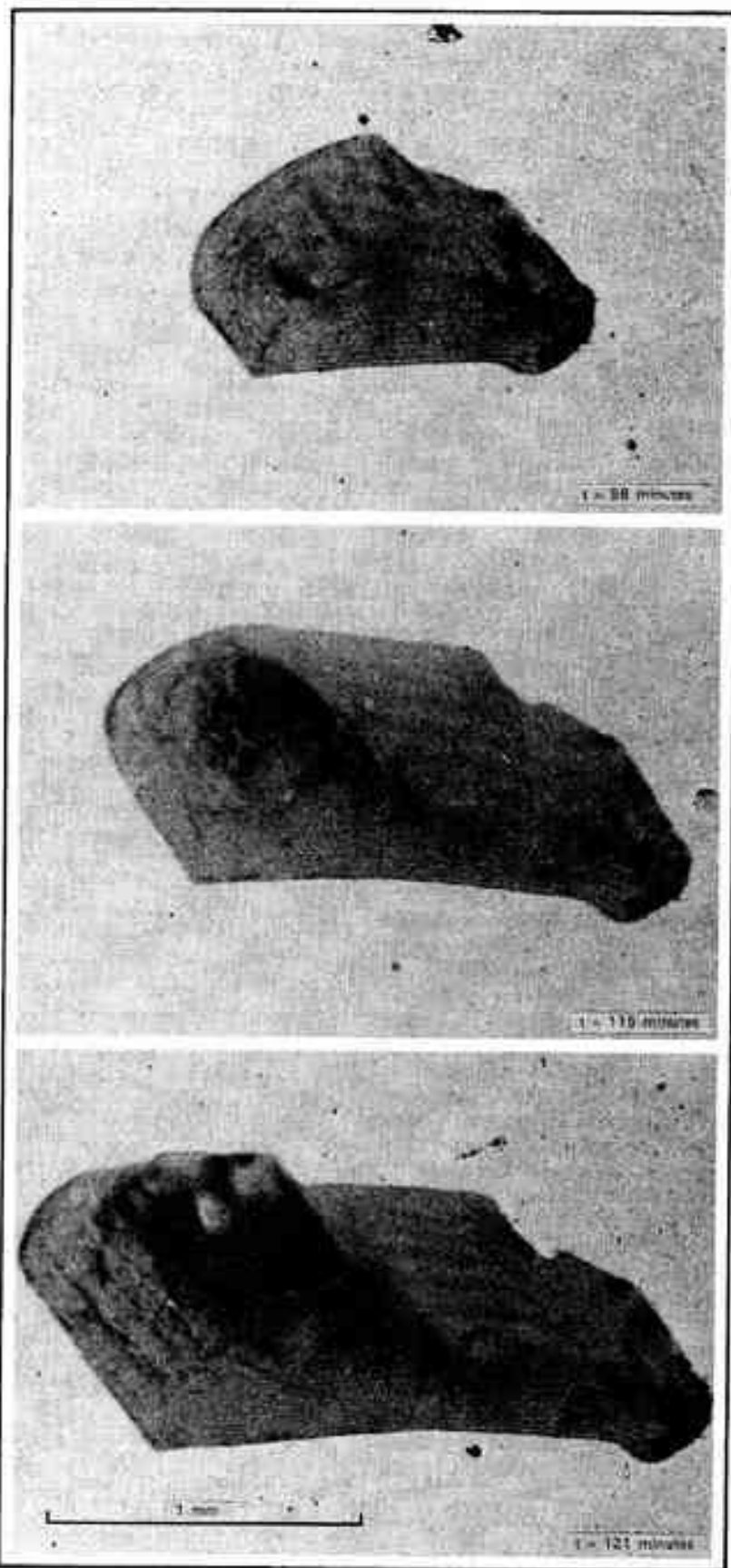
Fig. 2 - Ces clichés de topographie des rayons X ont pu être obtenus grâce à la grande intensité du rayonnement synchrotron. Les temps de pose, de l'ordre de la seconde, permettent de suivre l'évolution temporelle d'un phénomène. C'est ici la recristallisation de cristaux d'aluminium dans une matrice homogène.
