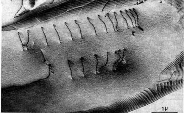
Acier înoxydable. Dislocations et moirés. Photographie prise au microscope électronique sous un million de volts. (Laboratoire d'optique électronique du CNRS - Toulouse).
