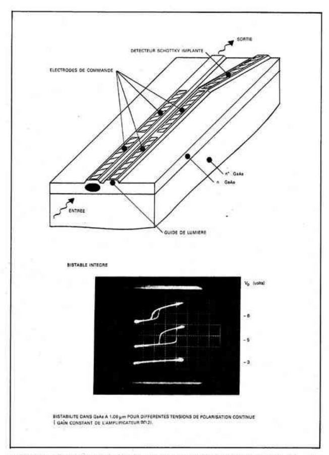
Fig. 2 – Schéma de principe d'un bistable intégré GaAs. Le coupleur directif est réalisé dans une couche épitaxiée de GaAs faiblement dopée , la commande de l'effet électro-optique est obtenue en polarisant en inverse les diodes Schottky localisées sur les deux guides de lumière. Le photodétecteur est du type à diode Sckottky réalisée sur une région de GaAs implanté.
