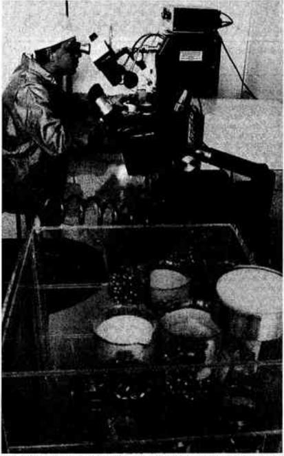
Technologie silicium et arsenic de gaillium. Microsoudure des connexions des circults. Liaison par fil de diamètre 25 microns du composant aux sorties du boltier. LAAS, Toulouse. (Photo Ph. Piailly – CNRS, octobre 1982, 23).
