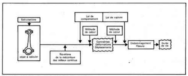
Fig. 2 - Organigramme d'un calcul de résistance de structures.
