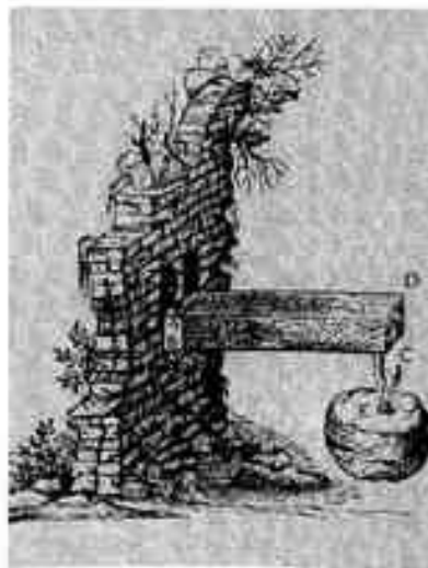
Fig. 1 - Essai d'une poutre en flexion (Galilée) - Extrait de Discorsi e dimostrazioni matematiche (Leyden 1638).
