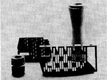
Conducteurs réfractaires ; la céramique zircons est un très bon isolant à température ambiante mais devient conductrice à 1000°C et devient alors élément chauffant électrique. (Centre de recherches sur la physique des hautes températures, Oriéans).
