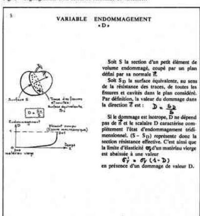
Tant que la dimension de ces fissures ou cavités reste de l'ordre de grandeur du cristal (1 à 100 µm), on peut fonder une mécanique de l'endommagement sur une variable continue (voir encadré 5) qui représente, « en moyenne », l'affaiblissement des sections résistantes de l'élèment de volume.
