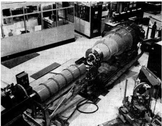
Fig. 3 - Le spectromètre D17 à l'ILL est utilisé par les métallurgistes pour des expériences de diffusion aux petits angles. On note le taille importante de cet instrument. Le fuisceau de neutrons arrive à gauche, un sélecteur de vitesse sélectionne l'énergie des particules. L'échantillon est placé entre les deux parties. La partie droite est le support d'un multidétecteur qui mesure l'ensemble du spectre diffusé.
