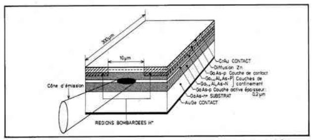
Fig. 1 – Schéma de principe d'un laser à semiconducteur. Dans le cas du laser GaAs-AlGaAs à 0,85µ m, la zone active de GaAs est associée à deux zones de confinement de AlGaAs. Le fonctionnement en régime continu implique la réduction de la largeur effective de la
