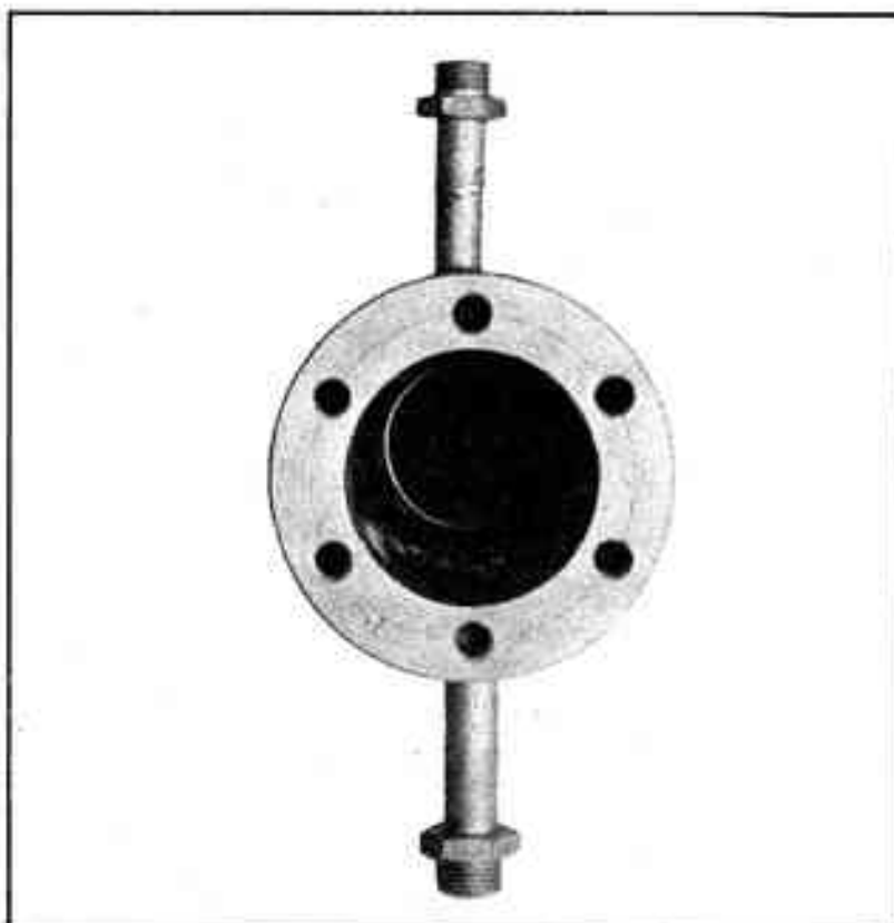
Fig. 4 - Echantillon métallique émaillé par du verre fluoré. Seules les parois internes du réacteur sont recouvertes de verre fluoré.
