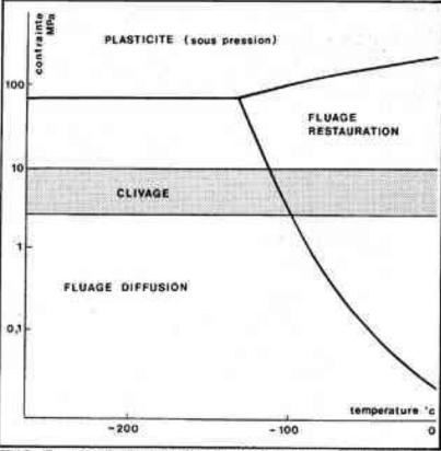
Fig. 3 - Carte des mécanismes de déformation de la glace simplifiée, d'après P. Duvai, M.F. Ashby, I. Anderman (1982). Taille de grain : 1 mm. En ordonnées la contraînte appliquée en MPa, en abscisses la température en degrés celsius.
