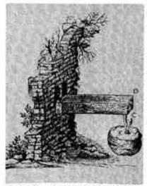
Fig. 1 – Essai d'une poutre en flexion (Galiièe) – Extrait de Discorisi e dimostrazioni matematiche (Leyden 1638).
