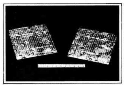
Fig. 3 - Photopiles en Si polycristallin. (Cliché CGE, laboratoire de Marcoussis).
