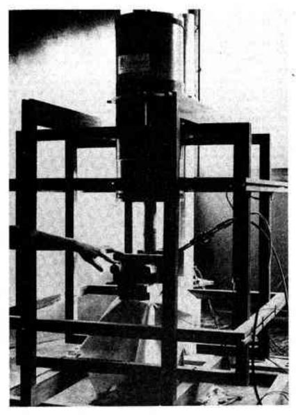
Fig. 4 – Presse amagnétique placée dans un magnétomètre cryogénique pour l'étude de l'inversion des titanomaghemites (Photo S. Coutin). Les cadres rectangulaires sont des bobines de Helmholtz destinées à compenser le champ magnétique terrestre.
