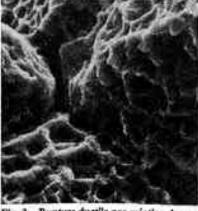
Fig. 3 - Rupture ductile par création de cavités au voisinage de joints de cristaux dans un acier. Grossissement 2000 x (d'après « Arlas of Metal Damage » Wolfe Siences Books, Munich).
