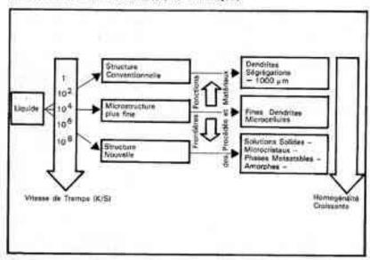
Fig. 3 - L'augmentation des vitesses de refroidinsement du liquide conduit à des microstructures de plus en plus fines dans l'alliage solidifié.
