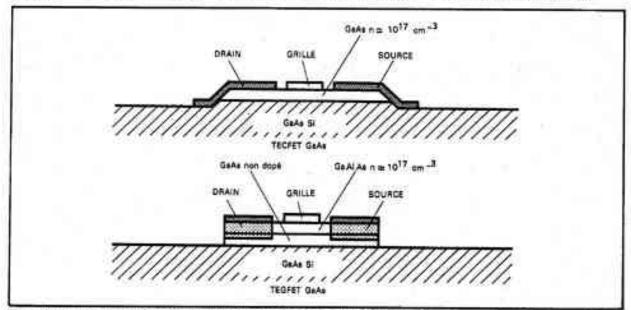
Fig. 3 - Schéma de principe de TEC (Translator à effet de champ) et du TEGFET GaAs réalisés our un substrat de GaAs semi-isolant (SI).
