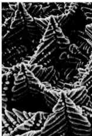
Fig. 1 - Cristaux de forme dendritique obtenus par solidification d'un acier. Microscopie électronique à balayage \times 100 . (Cliché Centre des matériaux).
