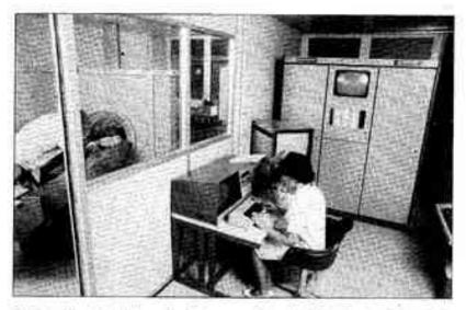
Fig. 2a — Vue générale du système de tomographie par émission béta (service hospitalier Frédéric Joliot, Orsay). Sur la gauche, le mainde est allongé sur le lit de la caméra, la tête du mainde située dans le champ de détection. Au premier plan, la console de commande du système et du traitement des données. A l'arrière plan, à droite, le calculateur et les systèmes de visualisation des images.
