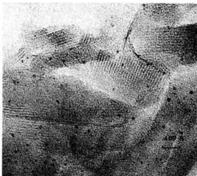
Examen par microscopie électronique haute résolution d'une coupe de catalyseur platine sur zéolithe. On distingue les plans cristallins (10 et 29) et les particules de platine (10 et 29) déposées dans la matrice zéolithique. © E.M. Flaud - Christiane Leclerc.
