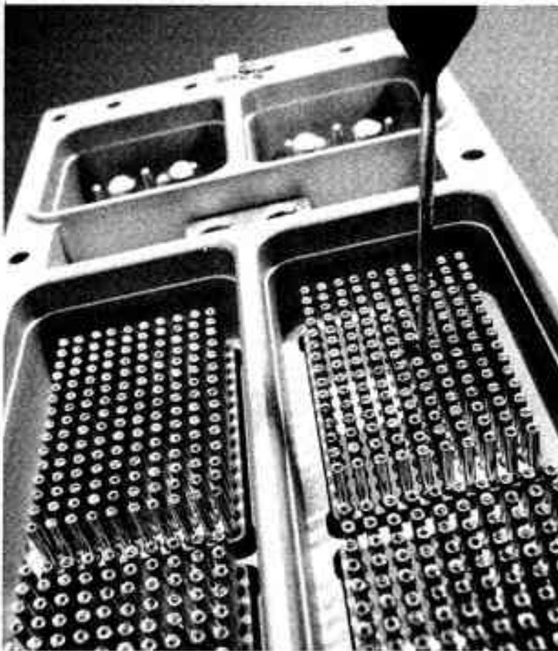
Ce connecteur (S-609) automatisé par Souriau comporte plusieurs centaines de points de contact. Il fera actuellement déployer une force de 30 à 50 kg pour relier les connectants. Grâce aux futurs alliages à mémoire de forme, cette force sera nulle, le contact sera meilleur et la superficie d'utilisation sera plus grande. Document Souriau et Cie.
