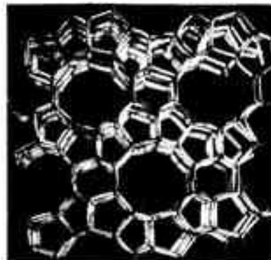
Structure moléculaire de la zéolithe ZSM5 utilisée par Mobil. © Laboratoire de chimie organique physique appliquée.
