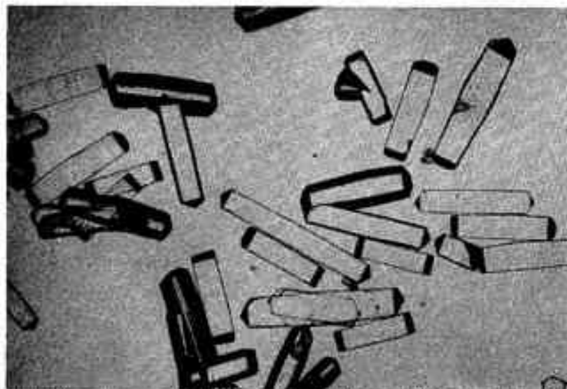
Photographie au microscope optique d'une borozéolithe (en haut) et d'une zéolithe (en bas). © Laboratoire de matériaux minéraux - Photo : Jean-Louis Gath.
