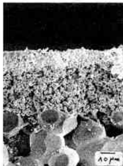
Vue en coupe, au microscope électronique à balayage, d'une structure minérale asymétrique. © Laboratoire de chimie des matériaux, Montpellier.
