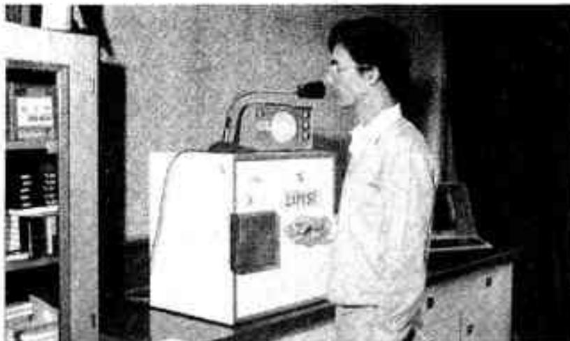
Cette serrure vocale mise au point au LIMSI demande au travailleur de prononcer son mot, puis un mot de parole confidentiel. Elle se a ouvert que si la vérification est positive. Le prototype figurant sur la photo est prêt à être exploité industriellement. © LIMSI.
