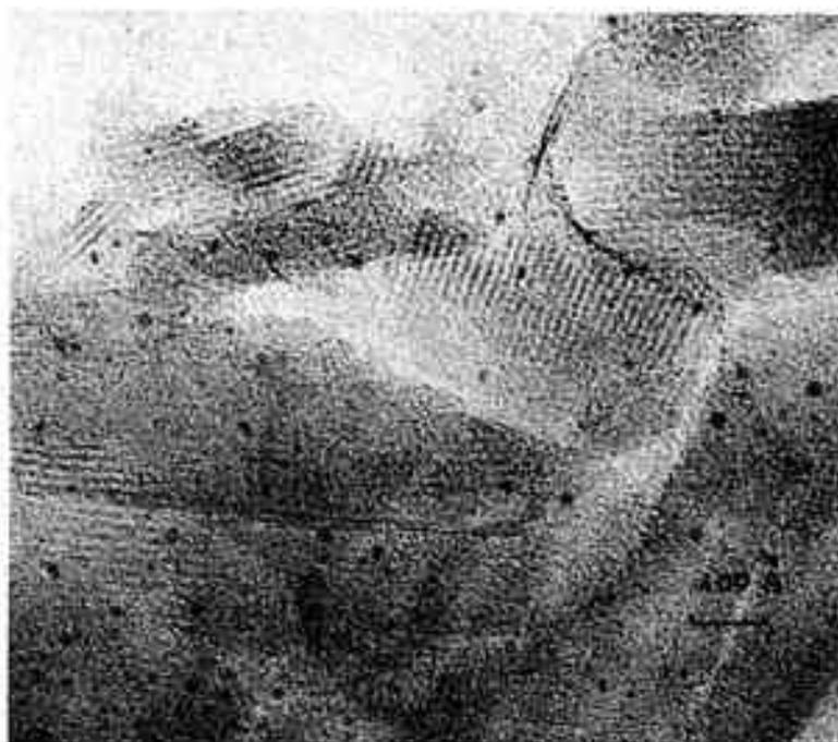
Examen par microscopie électronique haute résolution d'une coupe de catalyseur platine sur zéolithe. On distingue les plans cristallins (110 de la zéolithe) et les particules de platine (entre 10 et 29 Å) structurées dans la matrice zéolithe. © E.H. Flaud - Christiane Leclerc.
