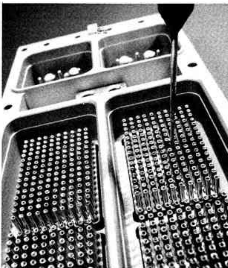
Ce connecteur (S-609) est introduit par Souriau comporte plusieurs centaines de points de contact. Il sera prochainement déployé une force de 30 à 50 kg pour réaliser les connectants. Grâce aux futurs alliages à mémoire de forme, cette force sera nulle, le contact sera meilleur et la souplesse d'utilisation sera plus grande. Document Souriau et Cie.
