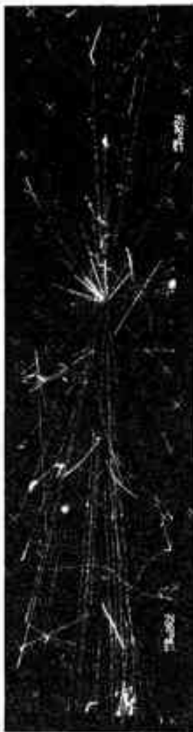
Fig. 3 : Photographie d'une collision proton-antiproton (expérience UA5). Une collision par dizaines de millions produit un W ou un Z dont les produits de désintégration doivent être identifiés parmi toutes les particules produites. © CERN.
