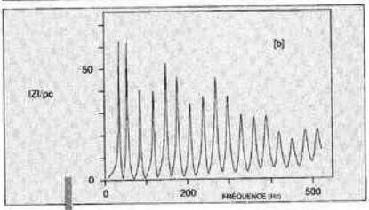
Courbe d'impédance d'entrée d'un tuba ([a] : expérience, [b] : calcul numérique). L'impédance d'entrée en fonction de la fréquence est une véritable signature acoustique de la forme intérieure d'un instrument à vent. La place et l'aculté des résonances donnent une indication respectivement sur le fréquences des notes jouées et leur facilité d'émission. ((C) René Caussé, IRCAM; J. Kergomard, Laboratoire d'accestique de l'université du Maine; X. Lurton, Thomson-Sintra).
