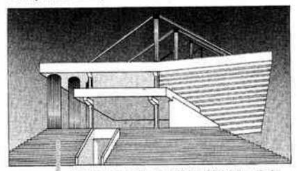
Il y a dix ans, cette structure aurait probablement été construite en acier. Les caractéristiques amétionées du béton à hautes performances, associées aux propriétés classiques du béton (durabilité, facilité d'entretien) permettent (ci une réalisation légère, architecturale.
