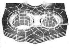
Fig. 2 Conceetrations de contrainte au régime maximum dans une cutasse Diesel (étude pour RNUR ; calcul Zébulon, EMP ; visualisation CAEDS-Supertab).
