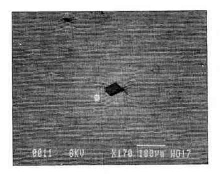
A la surface d'une éprouvette de superaffiage base nickel contenant une inclusion indéformable, on a déposé, par microlithographie, une grille métallique. L'éprouvette a ensuite été déformée en traction suivant une direction verticale.
