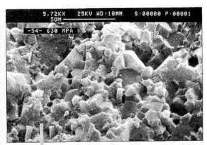
E'introduction d'une faible quantité de « whiskers » de carbure de silicium dans l'alumine permet de renforcer notablement la térracité et la résistance à la fatique statique de ce matériau. La figure montre des fragments de fibres extraîtes (en A) et les cavités la saées par l'extraction des fibres (en B). (@) Desmarquest-Pechiney)
