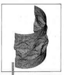
Fig. 1 - a) Coque cylindrique après flambage : compression axiale.
