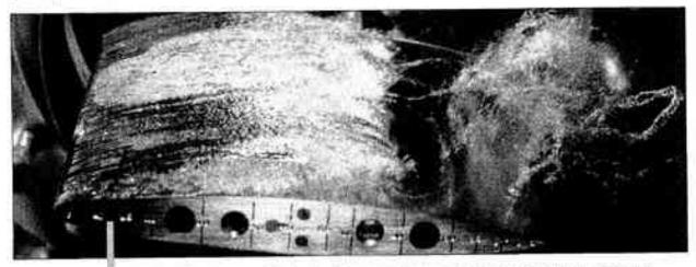
Cavitation développée sur une alle (l'eau s'écoule de gauche à droite) : cavité àccrochée au bord d'attaque, qui émet vers l'avail des poches organisées autour de filaments tourbillonnaires. (Cliché J.-P., Franc. IMG).
