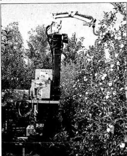
MAGAL I (1986) : prototype de robot de récobe de fruits conquiet mis au point par le CEMAGREF, le LAMM. L'IRIAM et l'entreprise Pellenc et Motte. Le LAMM, Laboratoire d'automatique et de microélectronique de Montpeller (UA CNRS 371), a plus particulièrement participé à la concèption du bras et de sa motorisation.
