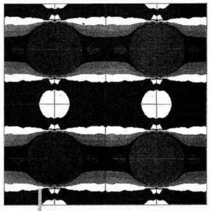
Carte de la contrainte équivalente dans une extension macroscopique transverse (horizontale sur la figure) d'un composite à fibres circultires. Les zones les moins sollicitées sont en blanc, les plus sollicitées en rouge. Les fibres, plus raides, supportent une contrainte plus importante que la matrice. Ce report d'efforts est la base du ronforcement par les fibres. (© Pierre Suquet)
