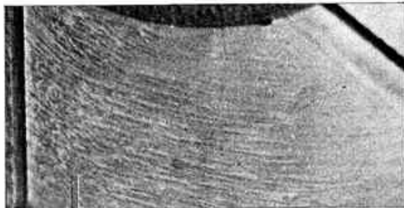
Visualisation de l'écoulement dans le film lubrifiant d'une butée hydrodynamique lubrifiée à l'eau : développement des tourbillons en régime non laminaire
