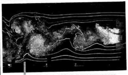
Visualisation du siliage turbulent d'un ensemble de barratur. à noter la coexistence de grosses structures organisées et de mouvements tourbillonnaires de diverses échelles et la diffusion des colorants dans la zone turbulente. (ED IMST).
