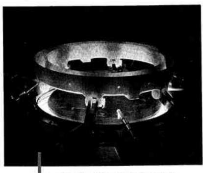
Essal de fatigue thermique, Plêce composite céramique/céramique.
