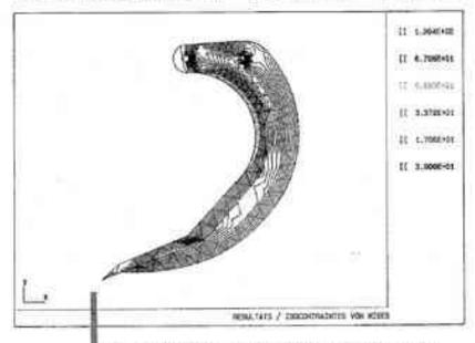
Fig. 1 - Le machinisme agricole fait aujourd'hui appel aux méthodes des - éléments finis - Caicut d'un chissé, sorte de croc de labour : représentation de la répartition des tensions (contraintes de Von Mises) dans la pièce mécanique. (11/03/1988 - Castor PC - CETIM).
