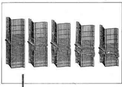
Fig. 2 - Simulation numerious de l'écrasament d'une éprouvette sous un choc (étude de faisabilité J.R.C.). ((2) PSA).
