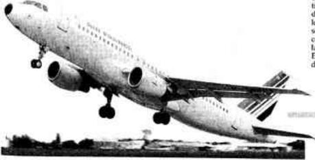
L'avion A 320 n° 2 en cours d'essain à Toulouse. Il peut être équipé des moteurs CFM 56-5 ou V 2500 (printemps 1989). (© Aérospatiale).
