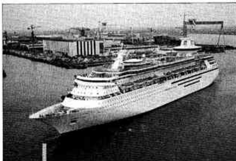
Paquebot "Sovereign of the Seas", construit par les chantiers Aisthorm-Atlantique pour la "Royal Caribbean Cruise Line". Longueur 266 mètres, largeur 32 mètres, tirant d'eau 7,6 mètres. Quatre moteurs totalisant 27 800 chevaux animent deux hélices à pales orientables. Vitesse supérieure à 21 nœuds. De nombreux essais sur maquettes ont eu lieu en bassin de traction, en bassin de houle et en bassin de cavitation. Les hélices ont été essayées en tunnel à cavitation. (© Studio Baudry - Cliché P. Depelteau - Saint-Nazaire).
