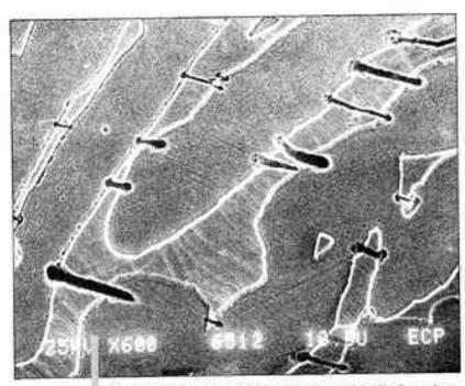
Fig. 3 - Micrographie d'un acier austénoferrifique montrant des chivages dans la ferrite qui se sont produits le long de plans cristallographiques orientés perpendiculairement par rapport à la contrainte. On distingue égalament des lignes de glissement.
