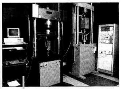
Ensemble de machines d'essau hydrautiques : traction compression ± 100 kelvin-newton avec équipement de flexion torsion ; traction-compression-torsion (± 63 kelvin-newton; ± 1 000 newton-mêtre ) avec équipement d'extensomètrie blaxiale (réalisation LMA).
