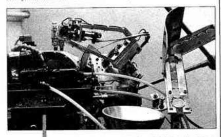
Mécanisme à un seul moteur permettant de prendre les boilters de montres - à droite sur la photo - et de les mettre en position sur le tour - partie gauche de la photo.
