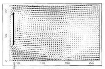
Ecoulement tridimensionnel instattonnaire d'un fluide incompressible autour d'un disque à un nombre de Reynolds de 170 : détaits d'une coupe diamétrale après 3 500 pas d'automate (simulation sur CRAY 2 du Centre de calcul vectoriel pour la rechérche, effectuée par J.-P. Rivet, Observatoire de Nice).
