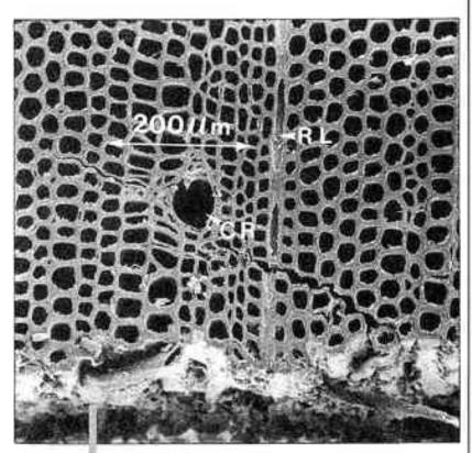
Aperçu de l'état de surface de la face inférieure d'un placage de pin de Douglas, cheminement d'une fissure. CR = canal résinifère. RL = rayon ligneux. (65 M. Thibaut, UA 1214 CRRS - Montpellier).
