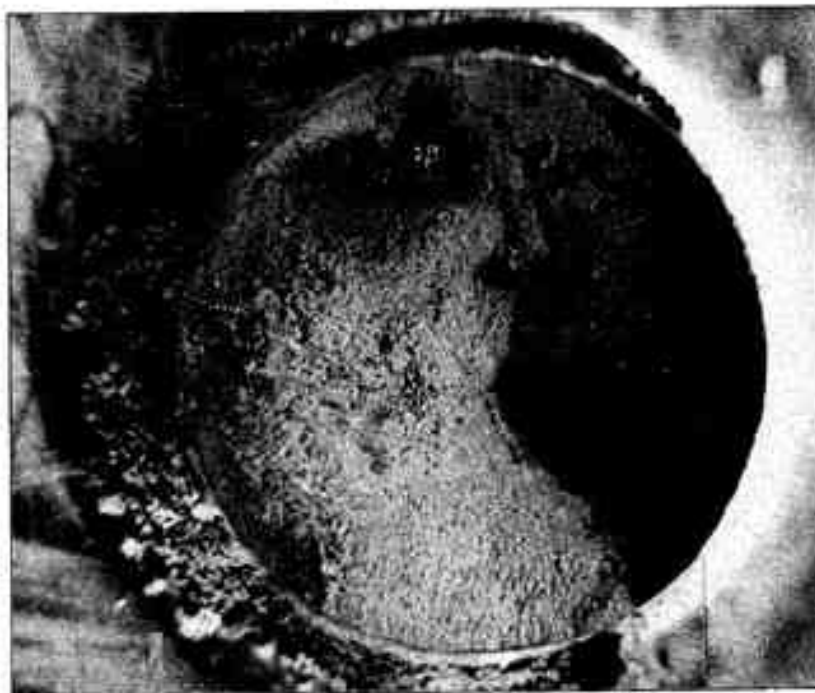
Troisième corps obtenu en cours d'essais de frottement alternatif entre éprouvettes d'acier.
