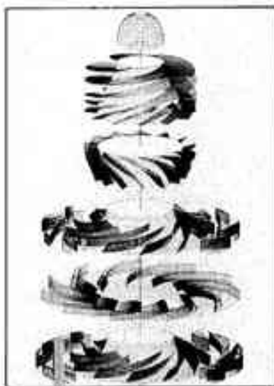
Vue éclatée d'une pompe de fusée inducteur - redresseur - deux impulseurs (photo SEP).
