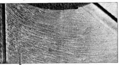
Vigualisation de l'écoulement dans le film lubrifiant d'une butée hydrodynamique lubrifiée à l'eau : développement des tourbillons en régime
