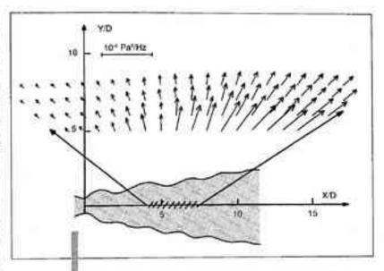
Carte du vecteur intensité acoustique près d'un jet subsonique (vitesse de sortie 135 m/s, diamètre de buse 2 cm, fréquence d'analyse 2 000 Hz). (Juvé et Roland, Revue d'Acoustique n° 66, p. 170).
