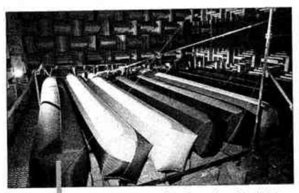
Retevé des caractéristiques acoustiques d'une parti en matériau plastique gonflable dans la grande chambre anécholique du Laboratoire de mécanique et d'acoustique du CNRS à Marsoille. (@LMA-CNRS).
