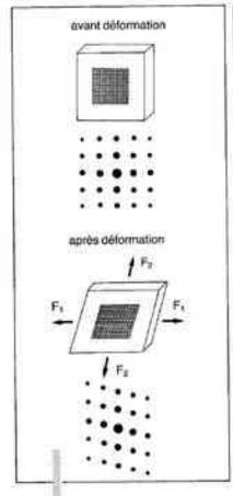
Figures de diffraction des réseaux par un faisceau laser.
