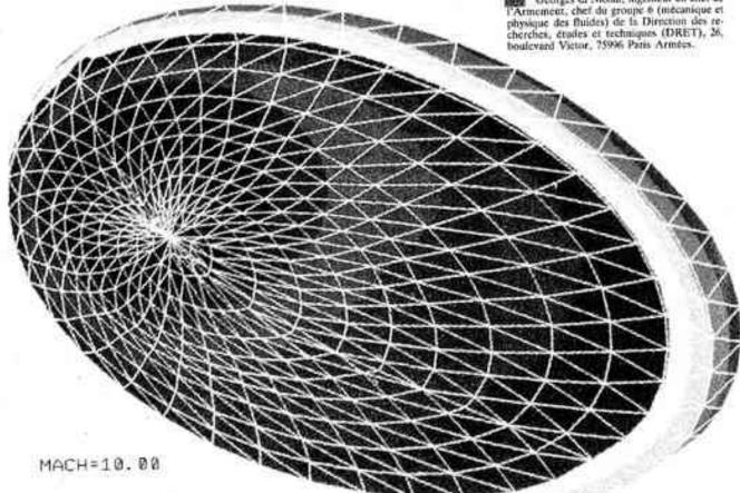
comme celui de l'avion spatial Hermès. Il faut prévoir l'échauffement et les caractéristiques aérodynamiques de ces véhicules avec la meilleure précision possible pour les dimensionner au plus juste. Doivent être considérés avec une grande attention la modélisation physique des problèmes d'aérodynamique
