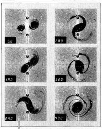
Fusion de tourbillons anticycloniques dans un fluide en rotation et stratifié en bicouches (simulation expérimentale). La période de rotation dans le même sons que la terre est de une seconde et le temps orbital est de 44 périodes. Le temps affiché sur les figures est en secondes. La différence de densite entre les deux couches affecte la distance critique de fusion. Au-delà de cette distance critique, les tourbillons restant en mouvement orbital.
