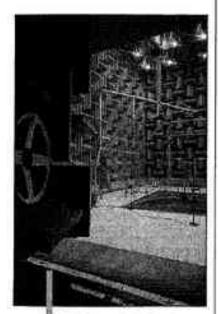
Chambre semi-anécholique de l'INRS; volume 500 m², isolament. en transmission 80 dB dés 60 Hz. bruit de fond inférieur à 10 d8
