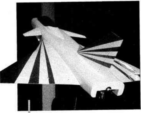
Maquette d'un avion type Rafair en soutturie subsonique, il s'agit d'une maquette instrumentée destinée aux essais en vol. (Cliche P. Ardonosau - UA 191).
