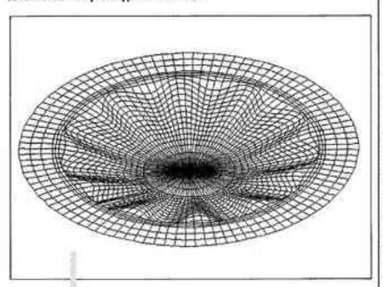
Simulation du plissement d'une tôle circulaire soumise à l'action d'un poingon cylindrique. (© division MNM/UTC).
