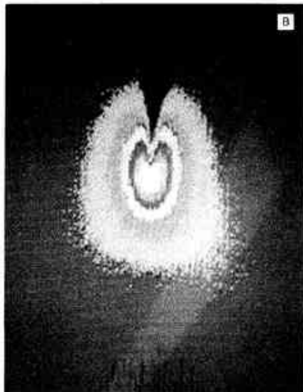
Propagation d'une fissure dans une plaque de métal sous chargement monotone (plaque d'acier de dimension 150 x 150 mm, épaisseur 1 mm). L'éprouvette fissurée est soumise à une traction à déplacement imposé, de façon à obtenir une propagation ductile stable tout au long de l'essai. On a observé deux phases dans la déformation et la rupture de la plaque. D'abord, la fissure immobile (A) : la déformation plastique est diffuse dans l'éprouvette, la zone chaude rappelle la forme de la zone plastique en contrainte plane avec deux lobes caractéristiques traduisant les effets des bords. Ensuite, la fissure en propagation (B) : les zones plastiques s'agrandissent régulièrement, les isothermes donnent avec précision les amplitudes de l'énergie dissipée et une meilleure compréhension des champs mécaniques en rupture ductile. (Clichés LMS, Ecole polytechnique, par Bui H.D., Ehrlicher A. et Nguyen Q.S.).
