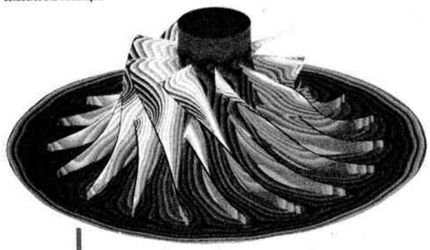
Simulation numérique, à l'ONERA, de l'écoulement dans le rotor d'un compresseur centrifuge (lignes isomach).
