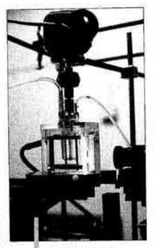
On volt ici un montage de laboratoire destiné à étudier les fluctuations de concentration dues au mélange imparfait d'un traceur dont la fluorescence (observés latéralement) est excitée par un taisosau laser (focalisé de bas en haut). Ces recherches sont menées à Nancy dans le codre de l'Action de recherche coordonnée PROMEF (Processus fondamentaux de mélange dans les fluides) du PIRSEM du CNRS.
