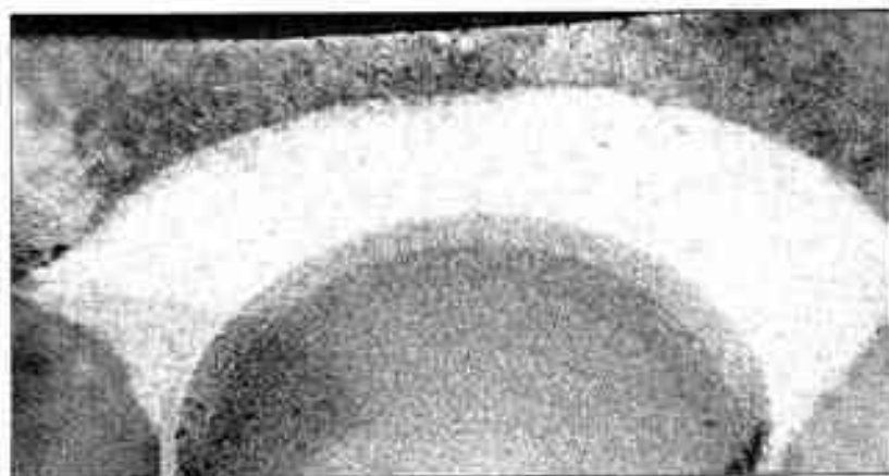
Propagation par fatigue (à 650 °C) d'une fissure semi-elliptique à partir d'un défaut initial en surface dans un alliage élaboré par métallurgie des poudres. On observe l'évolution de la forme de la fissure grâce aux marques laissées sur la surface de cassure à chaque arrêt du cyclage. Les différences de coloration sont dues à la fine pellicule d'oxyde formée à la surface.
