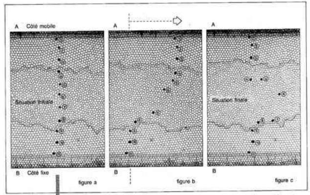
Expérience de simulation de frottement avec des bulles de savon : figure a, le lit cristalisé A se déplace parallèlement au il 8 avec une vitesse constante (1 mm/s). On note que toute la déformation se produit dans le lit amorphe central, grace à des déplacements relatifs de clusters de 5 à 6 bulles (figure b). La figure c carrespond à 20 déplacements aitemés.
