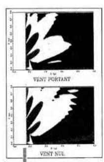
La propagation du son dans l'atmosphère: La modélisation numérique de plus en plus utilisée en acoustique industrielle est parfois la seule possible. On volt loi le calcul de l'effet d'écran sur la propagation du son provenant d'une source au voisinage du soi avec et sans vent. Par vent contraire, on observe que la zone d'ombre acoustique (zone bleus) est pou modifiée à proximité de l'écran, (65) EDF ACT)
