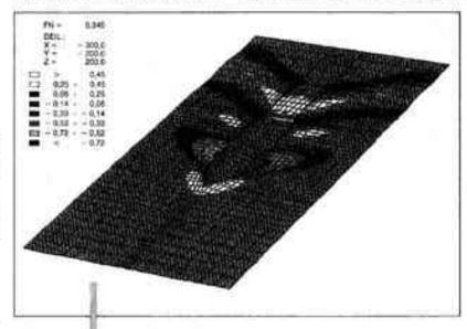
Déformation de surface de la mer à l'avancée d'un chalutier avec truibe. Image obtenue par voie numérique - code de calcul de résistance de vagues REVA.
