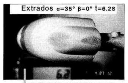
Visualisation, au moyen d'une peinture thermosensible, du flux de chaleur sur l'extrados d'une maquette type Hermès à Mach 8, 15 et 35° d'incidence. On remarque deux zones de flux élevé (rose) sur la verrière et le dos du fuselage. (Cliché J.-L. Da Costa - UA 191).
