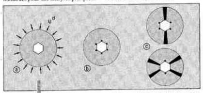
Progression de zones endommagées dans un cylindre avec un trou hexagonal.
