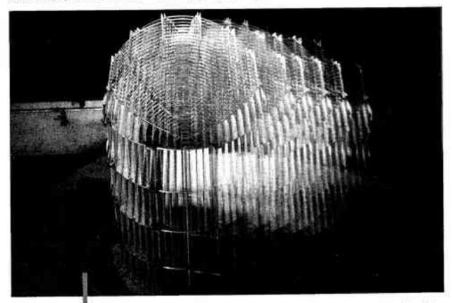
Comportement d'un générateur de vapeur de réacteur à eau sous préssion, soumis à un tremblement de terre. L'essai est effectué sur table vibrante et, parallèlement, des calculs ont été menés afie de simuler les mouvements observés. (Prioto CEA DEMT).
