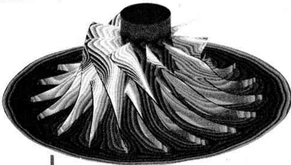
Simulation numérique, à l'ONERA, de l'écoulement dans le rotor d'un compresseur centrifuge (lignes isomach). (ONERA)
