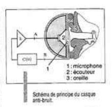
par un filtre électronique, amplifié et réinjecté dans la cavité. Leur efficacité est indépendante du spectre du bruit perturbateur et attaint plus de 30 décibels. Cette technique, objet d'un bruvet CNRS, intéresse plusieurs industriels français et étrangers; des modèles apparaîtront sur le marché d'ici peu.
