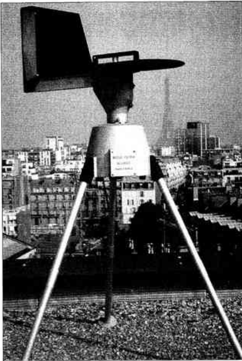
Appareil de Burkard de recueil des pollens. L'air chargé de particules en suspension est aspiré par une pompe à vide située dans l'appareil. Le flux pollinique est ensuite projeté sur un tambour rotatif sur lequel on applique une bande de melinex enduite de substance adhésive. Le tambour tourne à raison de 2 mm/h derrière un orifice de 2 \times 14 mm par où l'air est aspiré. Après exposition hebdomadaire, la bande est découpée en sept parties égales qui sont montées séparément entre lame et lamelle pour être examinées au microscope.
