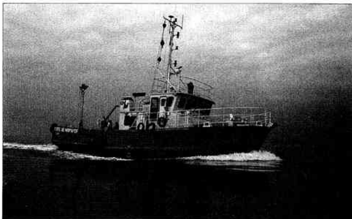
Le « Côte de Normandie », navire de la flottille côtière du CNRS-INSU lancé en 1984, contribue à l'étude de la dynamique des polluants en Baie de Seine et en Manche orientale. Longueur : 16,50 m. Surface de travail pont de 25 m 2 , laboratoire sec de 4 m 2 . (Cliché J.P. Auffret).
