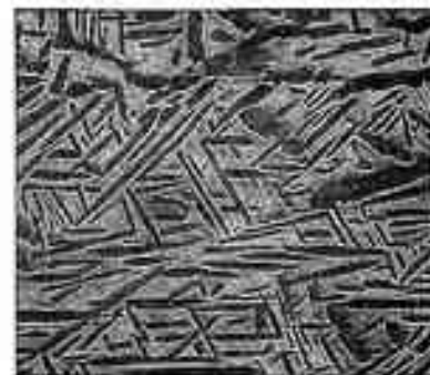
Alliage de titane bêta-CEZ, après traitement de mise en solution puis deux revenus à 820°C et 620°C. Microscopie électronique à balayage, grossissement \times 3000 . (© SNECMA)
