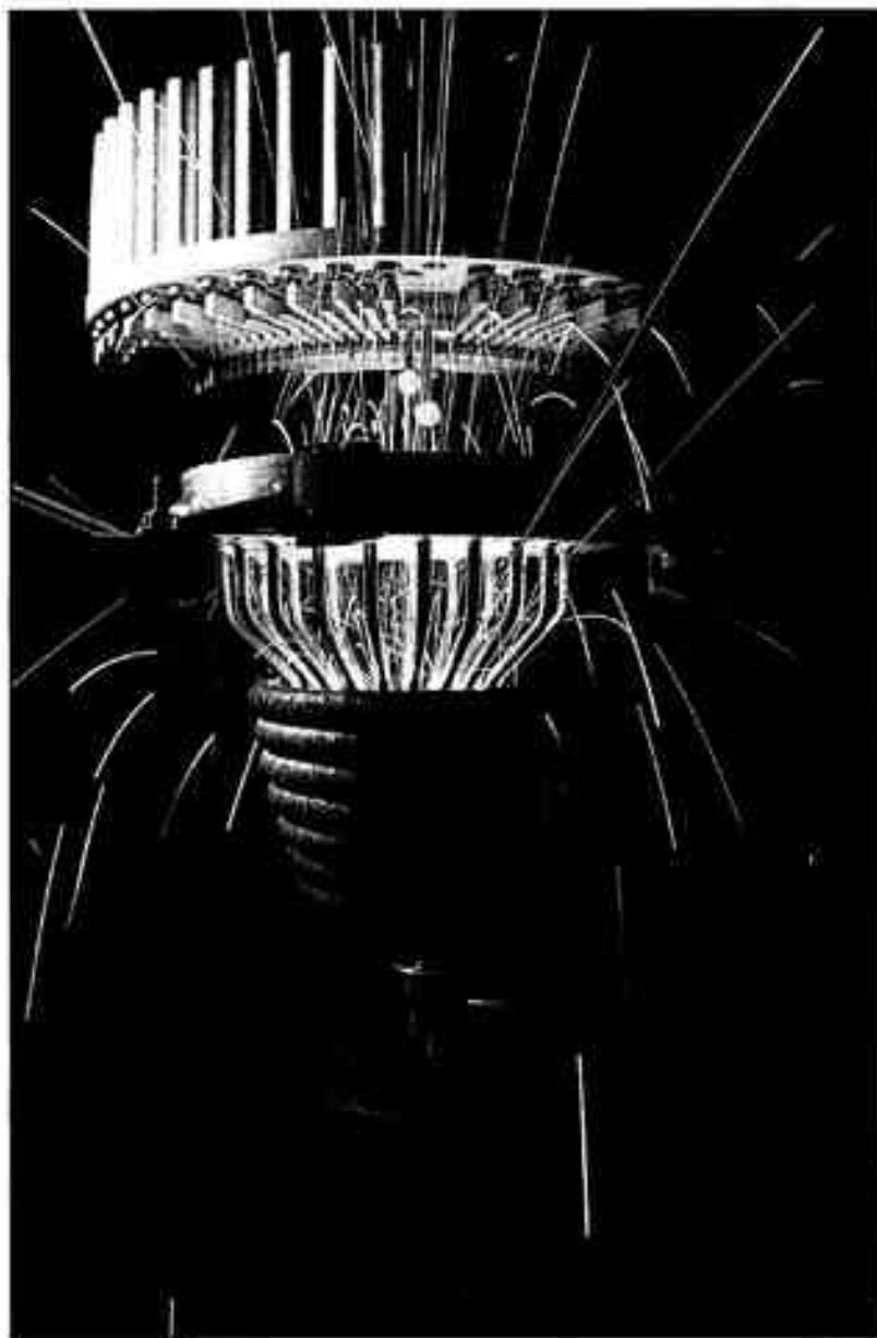
La « coulée 4C » permet de recycler les copeaux d'alliage de titane produits lors de l'usinage de pièces pour l'aéronautique. (©JIMAGINE, Grenoble)
