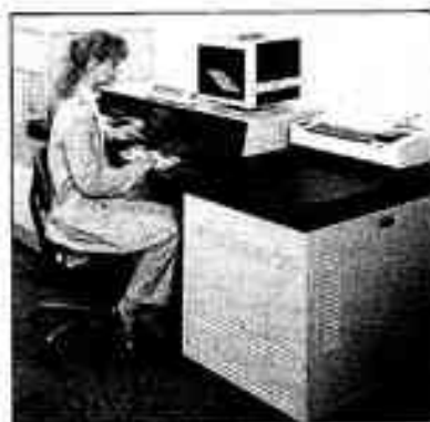
Appareil de résonance magnétique nucléaire (RMN) type MSL 300 permettant l'observation de tous les noyaux quel que soit leur état physique.
