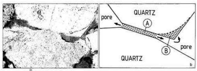
Fig. 3 - a) exemple de dissolution (au contact en A) et de recristallisation (nouvelle limite du grain en B) dans un grês de Fontainebleau. (Cliché D. Jeannette). b) schéma explicatif du cliché : le matériau dissous dans la zone sous contrainte.
