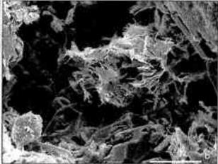
Détaits d'un grès réservoir au microscope électronique à baluyage. Remplissage de pores par des plaquettes (dickite, figure a) ou des fibres (illite, figure b) de minéraux argileux, avec une surcroissance de quartz dans le coin supérieur gauche. La barre dans le coin inférieur droit correspond à 10 µm.
