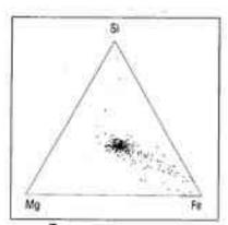
Fig. 2 - Une coupe ultramince de ce fragment de grain a été analysée par J. Bradiey; avec un microscope analysique de 250 kV. Chaque point de ce diagramme correspond à l'analyse en mode automatique des concentrations en silicium, magnésium et fer dans un très petit volume (un militième de micron cube). La dispersion de 200 analyses donne une empreinte digitale très caractéristique du grain, qui permet de le comparer aux météorites et aux micrométéorites stratosphériques.
