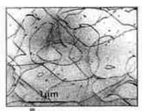
Quartz déformé : dislocations (lignes noires) observées par microscopie électronique à transmission.
