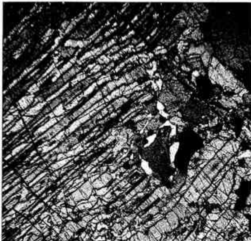
Fig. 2. Démixtion d'un pyroxène de haute température. Une phase initiale homogène calcomagnésienne, stable vers 1 350 °C, est maintenant remplacée par l'association intime d'une phase calcique jaune (diopside) et d'une phase magnésienne grise (enstatite), stable vers 800 °C. Longueur de la photo : 5 mm. (Cliché J. Kornprobst).
