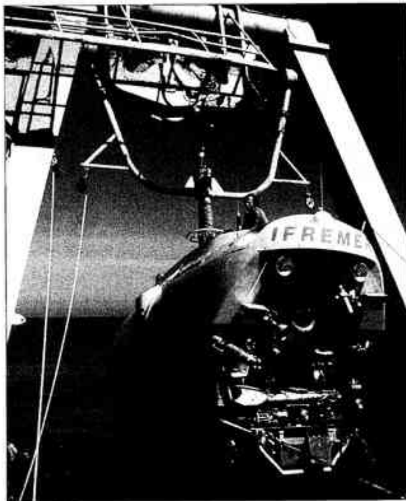
Le submersible français Nautilus peut plonger à moins 6000 m avec trois personnes à bord (deux pilotes et un scientifique). Il est équipé de plusieurs caméras photo et vidéo, et ses deux bras articulés permettent de prélever des échantillons stockés dans un panier rétractable et de manipuler des instruments sur le fond. (Cliché IFREMER).
