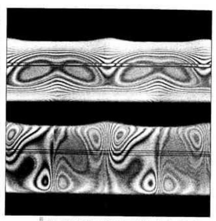
Fig. 1. Image de la convection dans un liquide dont la viscosité diminue très fortement avec la température. Le rapport de viscosité atteint 1 000 entre le haut (porté à - 16°C) et le bas (66°C). Les lignes d'égal gradient de température sont visualisées dans un plas vertical grâce à une technique interférométrique (gradient vertical en haut, horizontal en bas). Expérience réalisée par Franck Richter (Chicago) et l'auteur.
