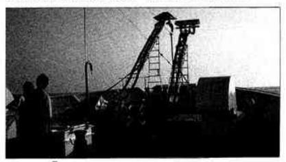
L'aérosol est collecté depuis le navire Le Surolt, campagne Phycemed 2, en utilisant des impacteurs à cascade placés sur des échelles fixées à l'avant du navire. Les pompes qui servent à accumuler les aérosols sur des filtres sont commandées par une girouette d'in d'éviter tout risque de contamination du bateau. (Cliché A. Sallot).
