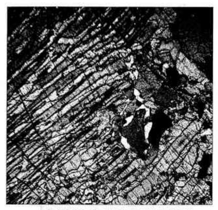
Fig. 2. Démixtion d'un pyroxène de haute température. Une phase initiale homogène calcomagnésisnne, stable vers 1 350°C, est maintenant remplacée par l'association intime d'une phase calcique jaune (diopside) et d'une phase magnésienne grise (enstatite), stable vers 800 °C. Longueur de la photo: 5 imm. (Cliché J. Komprobst).
