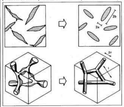
Fig. 1 - Pores apiatis non connectés (en haut). La porosité réelle (à gauche) est décrite par un schéma simplifié à deux paramètres (à droite). Le module élastique de la roche M varie avec Φ/A scion la loi M = M<sub>α</sub> (1-c Φ/A).
