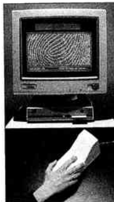
Système d'authentification automatique par empreinte digitale. Après saisie de l'image de l'empreinte à l'aide d'un capteur optique, une matrice de directions (orientations des crêtes de l'empreinte) et un détail de l'image de l'empreinte (une petite zone riche en informations caractéristiques) sont extraits puis comparés à la référence. Le taux de bonne reconnaissance est de 99% pour un seuil de sévérité moyen. (© SEPT).
