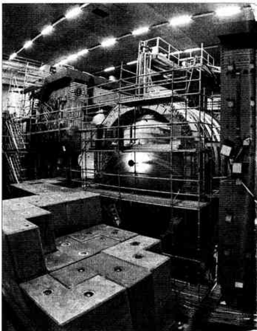
Vue du détecteur H1 dans son hall expérimental, situé 30 m sous terre. Le CNRS contribue essentiellement au composant central du détecteur, un calorimètre à argon liquide de 300 tonnes dont on voit ici la paroi externe du cryostat - RD Nick Hall Photography.
