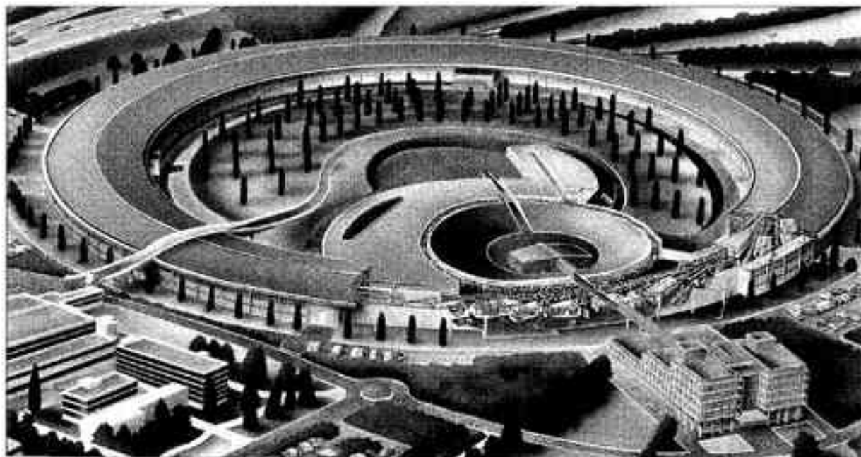
Vue artistique éclairée de l'ESRF. Au centre en haut, on voit le pré-injecteur, accélérateur linéaire d'électrons de 200 MeV ou de positrons de 400 MeV.
