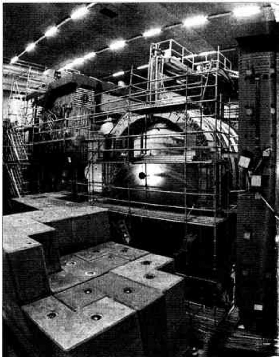
Vue du détecteur H1 dans son hall expérimental, situé 20 m sous terre. Le CNRS contribue essentiellement au composant central du détecteur, un calorimètre à argon liquide de 500 tonnes dont on voit ici la paroi extérieure du cryostat. (© Nick Wall Photography).
