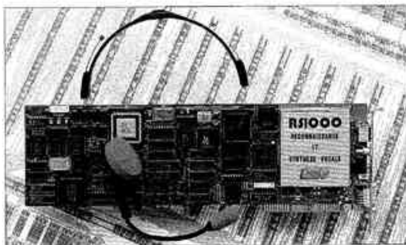
Carte d'interface vocale, développée par la société viscom à partir des travaux du LMS/CNRS. En mode monolocuteur, cette carte permet de reconnaître des phrases construites à partir de plusieurs centaines de mots prononcés en continu (schéma viscom).
