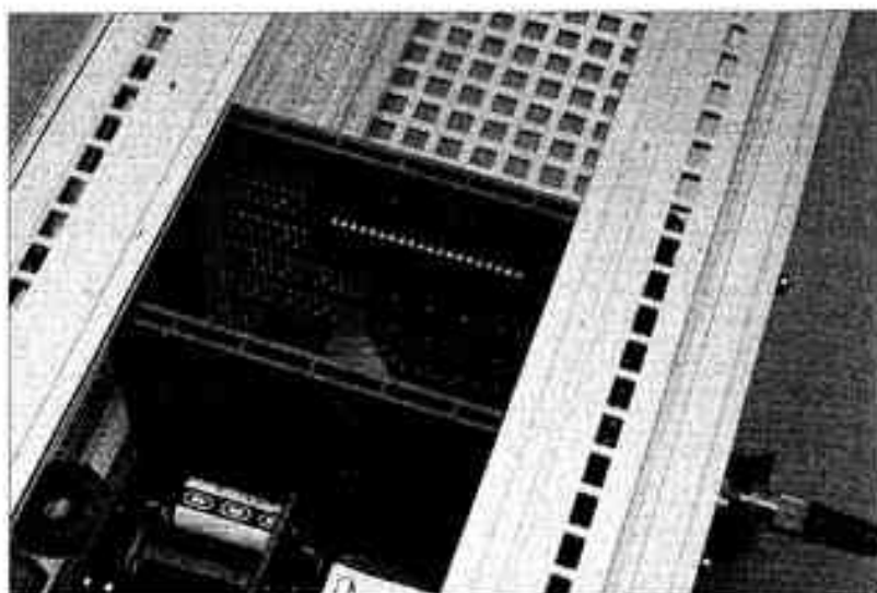
Générateur optique de tableaux de nombres aléatoires parallèles. (P. Lalanne et J.-C. Rodier, Institut d'optique, en collaboration avec l'Institut d'électronique fondamentale, Orsay, URA 22 CNRS).
