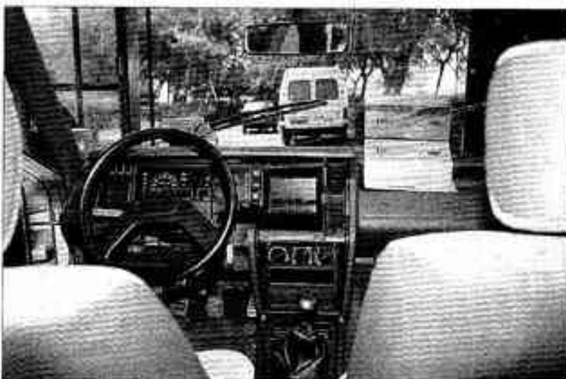
Tableau de bord du véhicule ProLab 1. L'écran situé à droite du volant donne des alertes au conducteur par rapport aux manœuvres envisagées.
