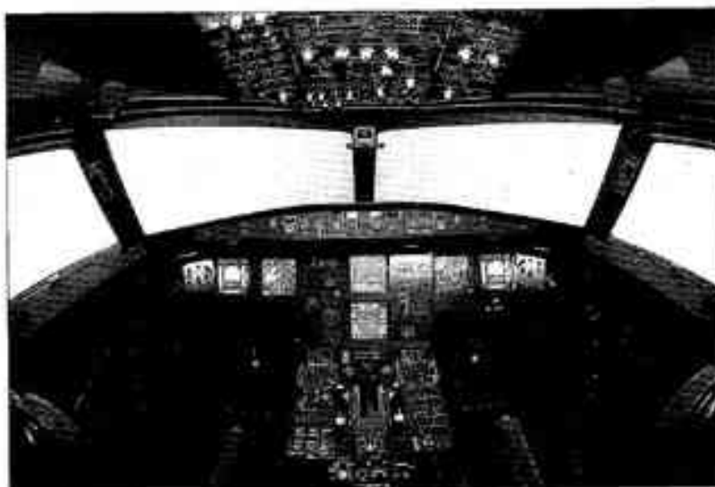
Cabine de pilotage de l'Airbus A320 : par rapport aux avions de la génération précédente, on assiste à une simplification du tableau de bord HD A. Erroult.
