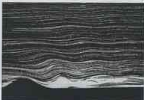
Fig. 3 - Simulation en veine hydraulique d'un phénomène atmosphérique : ondes internes à la verticale d'un relief (« vents » de gauche à droite)
