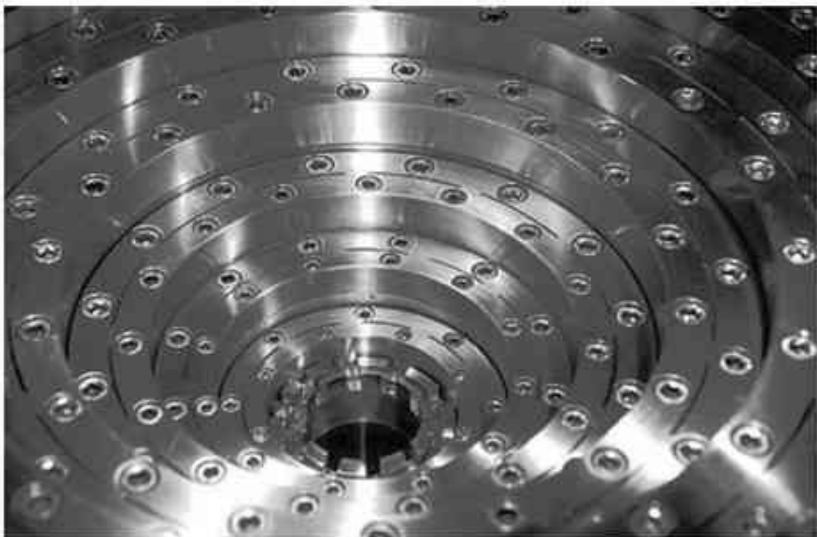
Au LCMH : partie interne de la bobine résistive du futur aimant hybride conçu pour produire 40 teslas. Les 14 hélices sont, ici, emboîtées et connectées entre elles. La bobine est prête à être montée pour les premiers tests.
