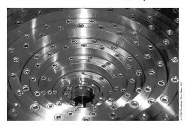
Au LCMI: partie interne de la bobine résistive du futur aimant hybride conçu pour produire 40 teslas. Les 14 hélices sont, ici, emboûtées et connectées entre elles. La bobine est prête à être montée pour les premiers tests.
