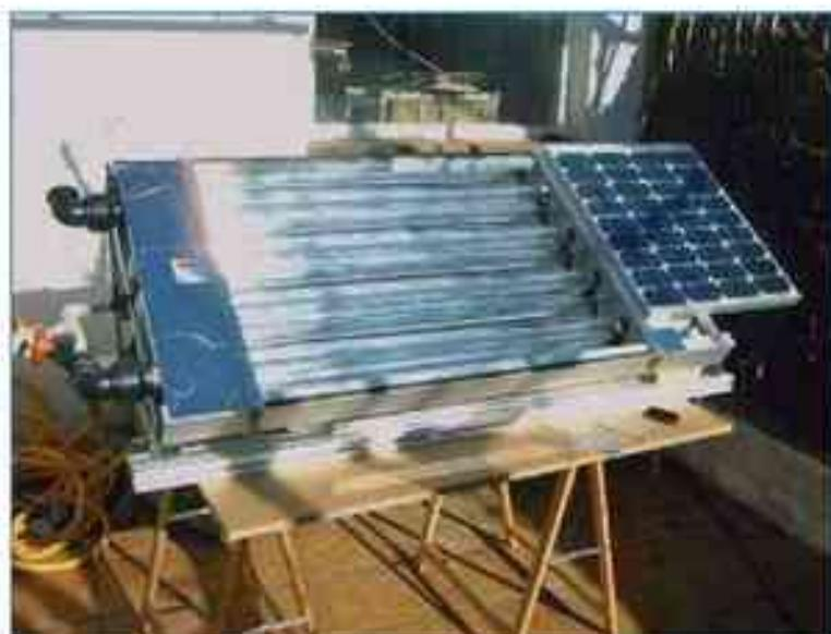
Photovoltaïque pilote solaire autonome pour la potabilisation de l'eau
