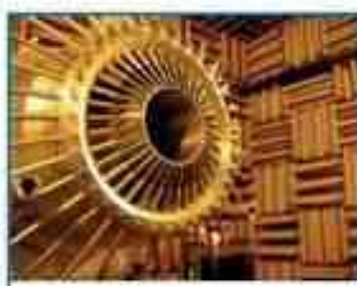
Figure 3 : Jet à mach 0.9 percé de 36 microjets qui perturbent la zone de mélange proche de la buse afin de diminuer la bruitierie, Thèse T. Carrière, ECL 2006.
