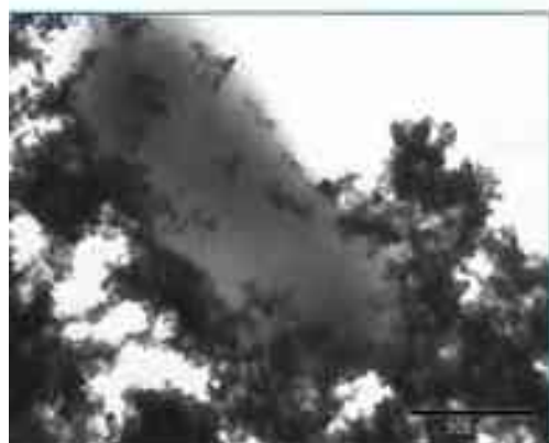
Dégradation photocatalytique de la bactérie E. Coli - exemple d'interaction entre des particules élémentaires de catalyseur \text{TiO}_2 et d'un «réactif supramoléculaire» bactérien.
