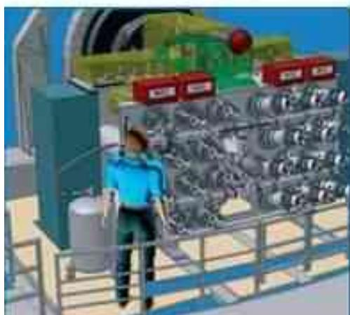
Représentation de l'instrument Musé au foyer du VLT, lui 24 modules optiques constituant l'instrument permettront d'obtenir un cube de données de 370 millions de pixels par pose.
