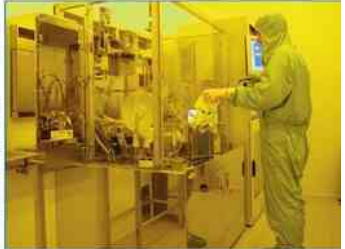
Fig.2 : Centrale de technologie du réseau RTB : Système d'induction/développement automatisé de résines photosensibles pour la réalisation de micro et nano composants.
