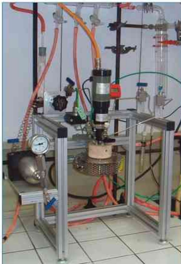
Fig 5 : Dispositif pour réaction catalytique sous pression. (CHFA/CNRS)
