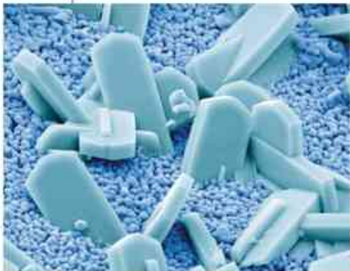
Les zéolithes sont des aluminosilicates microporeux ; largement utilisées comme catalyseurs dans l'industrie, elles interviennent de plus en plus dans les procédés de séparation. (Grossissement 5000x ; largeur de l'image 22,8 microns).
