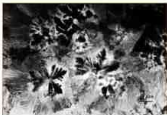
Figure 2 : une fois observé au microscope électronique, l'alliage aluminium-manganèse présente des nodules dendritiques de quelques micromètres qui se développent au sein d'une matrice d'aluminium)
