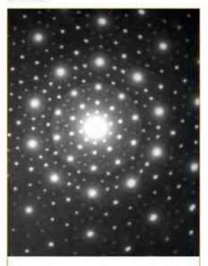
Figure 3 : observés selon certaines directions, les précipités dendritiques de la figure 2 présentent cette ringrafique figure de diffraction électronique où apparaissent des taches de diffraction fines qui se sépartissent selon des pentagones de différentes tailles
