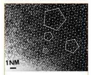
Figure 6 : après interférence des foliceaux diffractés de la figure 3 an abtent cette image de microxapie électronique en haute résolution qui montar la répartition des atornes au sein des dendates de la figure 2 avec, une distribution homogène et non périodique de pentagones.
