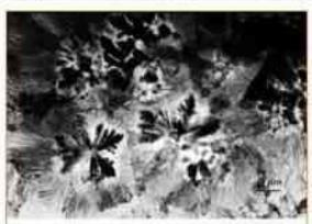
Figure 2 : une fois observé au microscope éléctronique. l'allage aluminium marganèse présente des nodules dendritiques de quelques micromètres qui se développent au sein d'une matrice d'aluminium)
