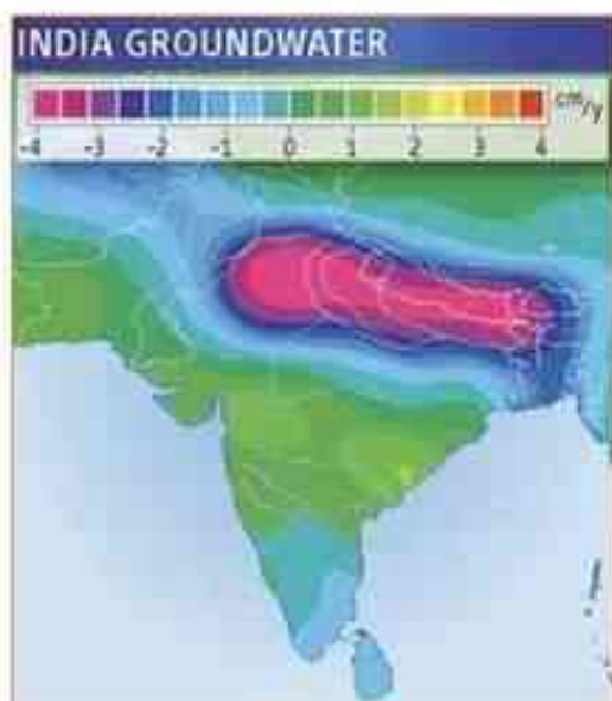
Fig. 7 : diminution du stock d'eaux souterraines dans le bassin du Gange entre 2002 et 2008, mise en évidence par la mission spatiale GRACE. Cette diminution a pu être attribuée au pompage de l'eau dans les nappes pour les besoins de l'irrigation des cultures (source : Tiwari, V.M., Wahr, J., Swenson, S., 2009. Dwindling groundwater resources in northern India, from satellite gravity observations. Geophys. Res. Lett. 36, L18401. doi:10.1029/2009GL039401).
