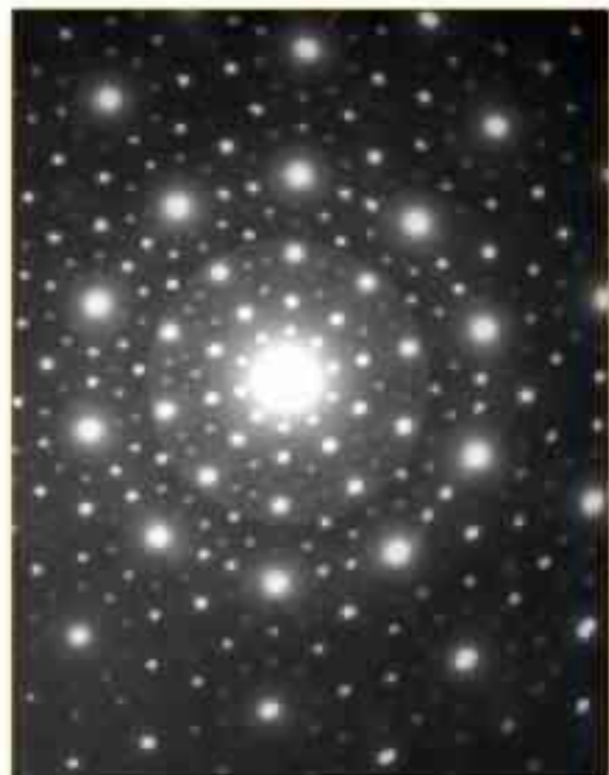
Figure 3 : observés selon certaines directions, les précipités dendritiques de la figure 2 présenteront cette magnifique figure de diffraction électronique où apparaissent des taches de diffraction fines qui se répartissent selon des pentagones de différentes tailles
