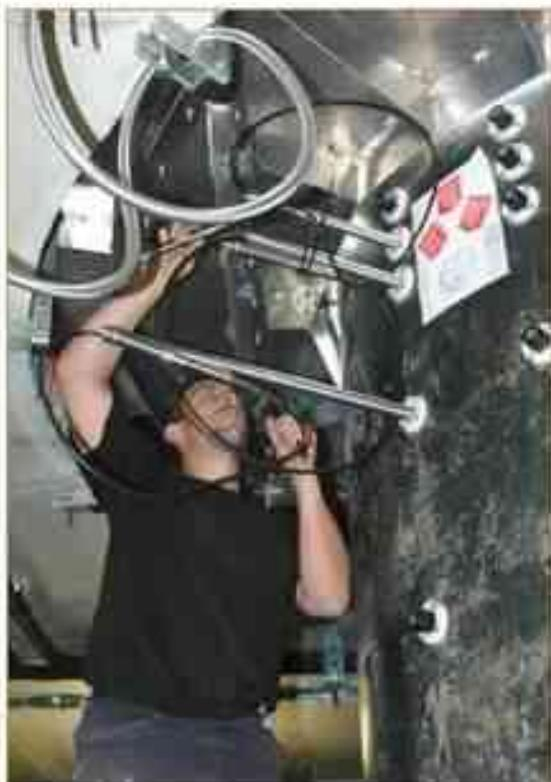
Photo 2. Dans les entrailles d'un microcosme. Ici il s'agit de l'enceinte en métal contenant le monoclope de sol. Sur cette photo nous voyons un expérimentateur mettre en place des tensiomètres. Les tensiomètres permettent de mesurer la force de succion des racines pour tirer l'eau du sol (photo Jacques Roy).
