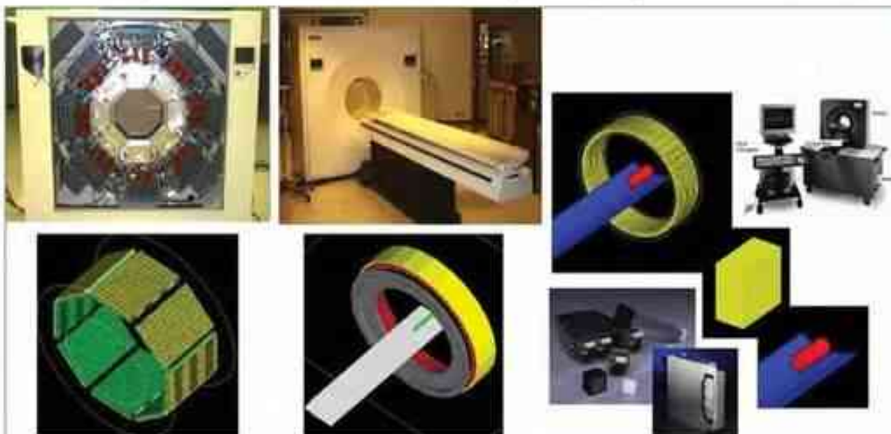
Fig. 2 : Représentation de la géométrie modélisée de différents systèmes utilisés en imagerie médicale par TEP, de gauche à droite nous avons un système pour l'imagerie cérébrale haute résolution, un système pour l'imagerie corps entier chez l'homme et enfin une caméra très haute résolution pour l'imagerie préclinique chez le rongeur.
