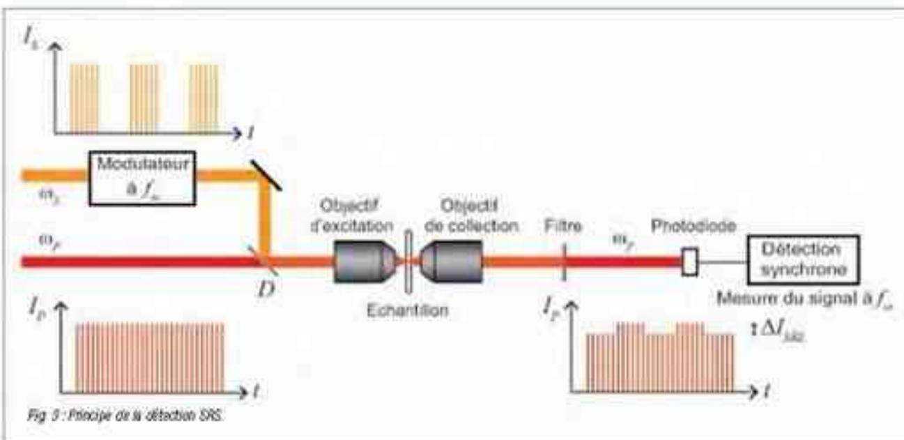
Fig. 3 : Principe de la détection SRS.
