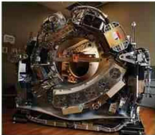
Fig. 7 : Photographie d'un scanner à rayons X actuel constitué d'un tube à rayons X (en haut à gauche), du bras de détecteurs (en bas), des alimentations et des systèmes de refroidissement, le tout monté sur un rotateur muni de collecteurs tournants.
