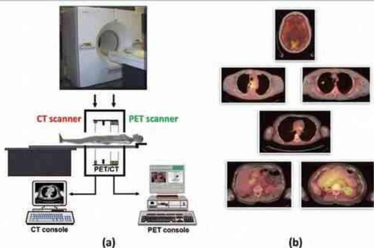
Fig. 5 : Le premier design de scanner TEP/TDM (a) combinant un scanner TDM spirale avec un scanner TEP rotatif montés sur le même support que le TDM. Les images TDM sont acquises en premier en déplaçant le lit de manière continue dans le scanner tandis que les images TEP sont acquises pas à pas discrètes comme illustré dans la Figure 4. Les images fusionnées (b) de la TDM et de la TEP sont affichées à l'écran pour lecture par le radiologue.
