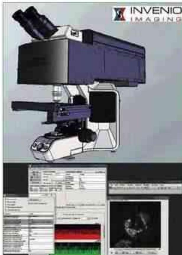
Fig. 4 : Le microscope SRS de la startup californienne Invenio Imaging intègre des sources filtrées qui délivrent des impulsions de 2 ps synchronisées aux longueurs d'onde de 730 nm et 1030 nm. Équipé d'un logiciel dédié, il s'agit du système d'imagerie Raman cohérent le plus compact au monde.
