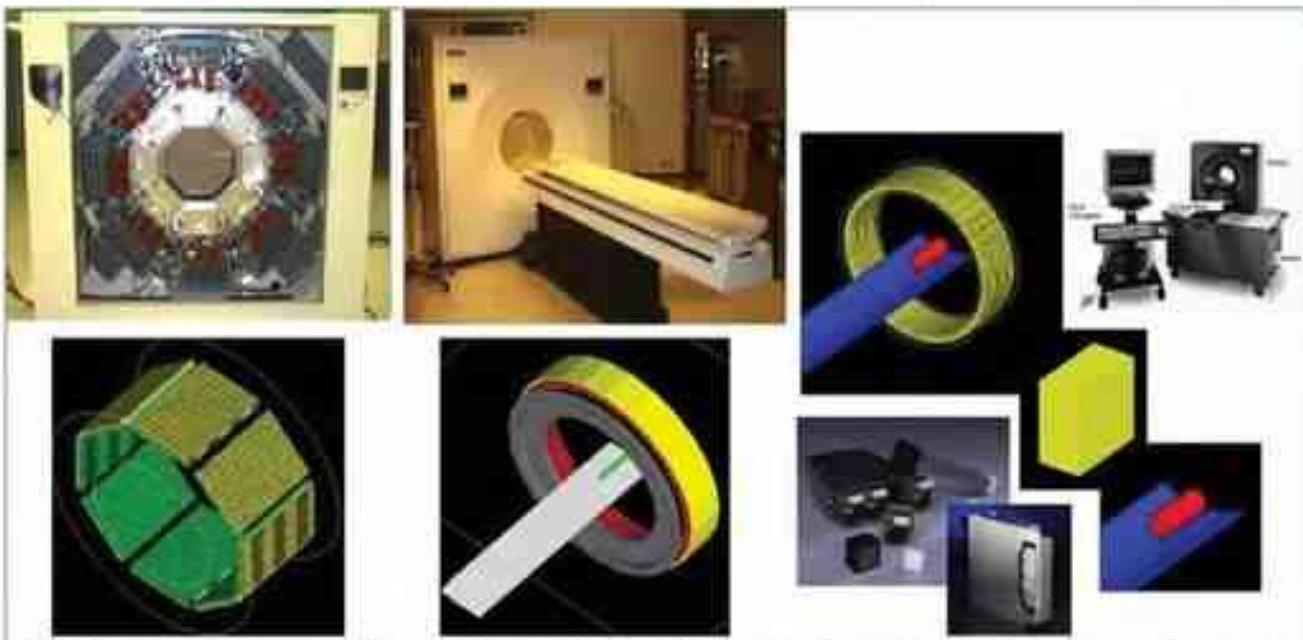
Fig. 2 : Représentation de la géométrie modélisée de différents systèmes utilisés en imagerie médicale par TEP, où de gauche à droite nous avons un système pour l'imagerie cérébrale haute résolution, un système pour l'imagerie corps entier chez l'homme et enfin une caméra très haute résolution pour l'imagerie préclinique chez le singe.
