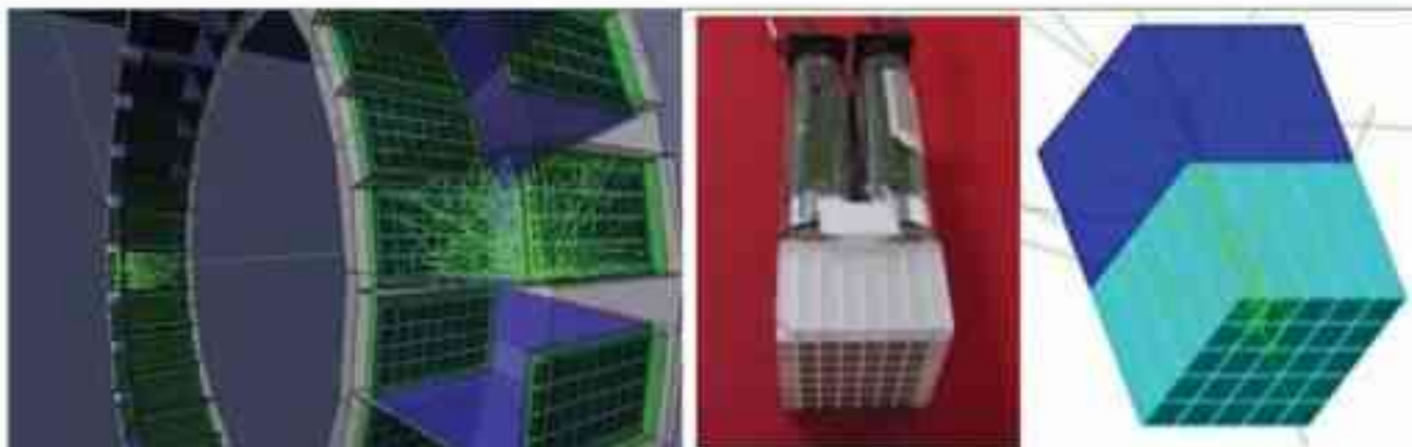
Fig. 1 : Modélisation d'un détecteur et de la réponse d'un cristal scintillant lors de l'interaction d'un photon B et représentation d'un bloc de détection utilisé en imagerie médicale par Tomographie à Emission de Positons où l'on distingue clairement le couplage entre une matrice de cristaux scintillants (BGO dans le cas présent) avec un ensemble de photomultiplicateurs dont la fonction est de convertir les photons de scintillation en un signal électrique exploitable.
