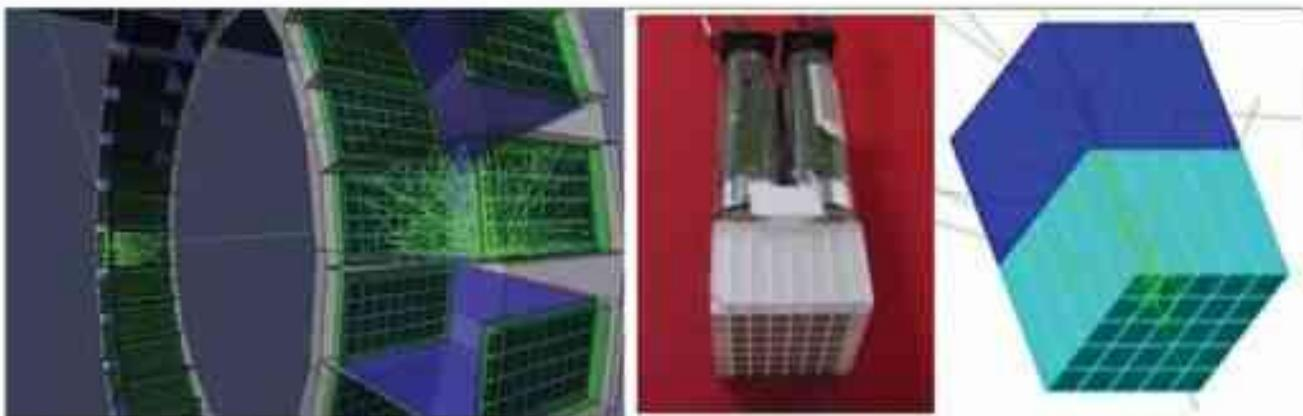
Fig. 1 : Modélisation d'un détecteur et de la réponse d'un cristal scintillant lors de l'interaction d'un photon B et représentation d'un bloc de détection utilisé en imagerie médicale par Tomographie à Emission de Protons où l'on distingue clairement le couplage entre une matrice de cristaux scintillants (BGO dans le cas présenté) avec un ensemble de photomultiplicateurs dont la fonction est de convertir les photons de scintillation en un signal électrique exploitable.
