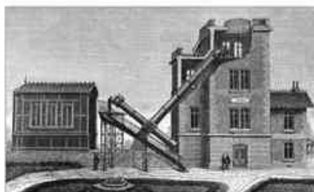
Figure 6. Le grand équatorial coulé de l'Observatoire de Paris, terminé en 1891. Construit par Paul Gautier (1842-1909) avec deux objectifs interchangeables de 60 cm de diamètre pour l'observation visuelle et la photographie des astres faibles, cet instrument permettait à l'observateur d'être assis confortablement au chaud, ceci au prix de deux miroirs plans de verre et d'une mécanique compliquée. L'instrument est actuellement démonté, et le bâtiment et l'abri roulant sont en très mauvais état, faute des sommes considérables qui seraient nécessaires à leur restauration.
