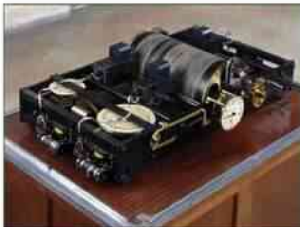
Figure 7. La première horloge parlante, construite en 1933 par les Établissements Brillé. Elle a été source de plusieurs autres réalisations à base d'électronique.
