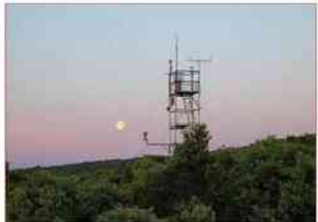
Photo 1. La tour de mesure des flux d'eau et de carbone. La vitesse verticale du vent est mesurée à l'aide d'un anémomètre-sonique 50, les teneurs en eau et gaz carbonique de l'air par un analyseur rapide. Des mesures de rayonnement solaire incident et réfléchi dans toutes les longueurs d'ondes complètent ce dispositif.
