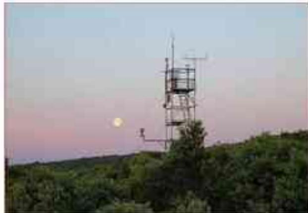
Photo 1. La tour de mesure des flux d'eau et de carbone. La vitesse verticale du vent est mesurée à l'aide d'un anémomètre sonique 3D, les teneurs en eau et gaz carbonique de l'air par un analyseur rapide. Des mesures de rayonnement solaire incident et réfléchi dans toutes les longueurs d'ondes complètent ce dispositif.
