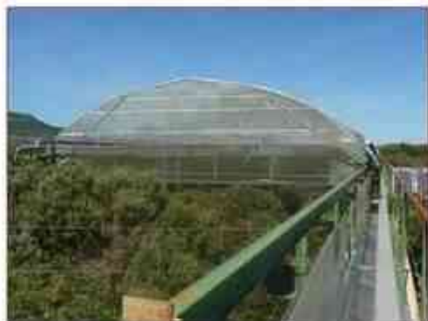
Photo 3. Dispositif d'exclusion totale de la pluie. Un toit mobile recouvre un fragment de la forêt lors des événements pluvieux. Déclenché automatiquement lors du début de la pluie, il recouvre celle-ci en 8 minutes. Il se retire à la fin de l'épisode.
