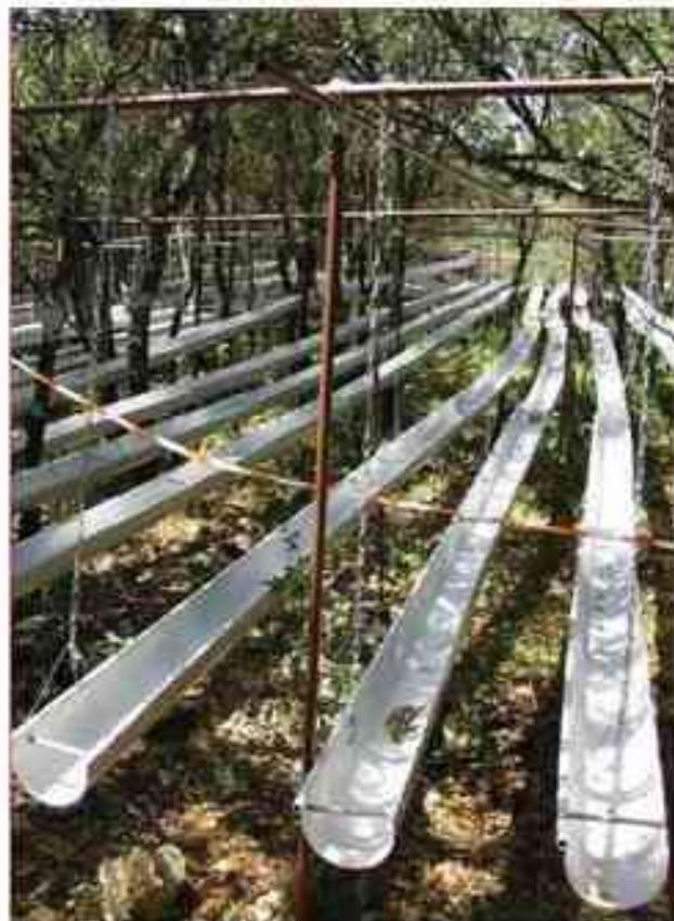
Photo 2. Dispositif d'exclusion partielle et continue de la pluie. Ce système de gouttières permet d'intercepter en continu 30% de la pluie depuis juillet 2003 sur un dispositif de 3 répétitions. Le fonctionnement de ces parcelles dites sèches est comparé à des parcelles humides ou cotées.
