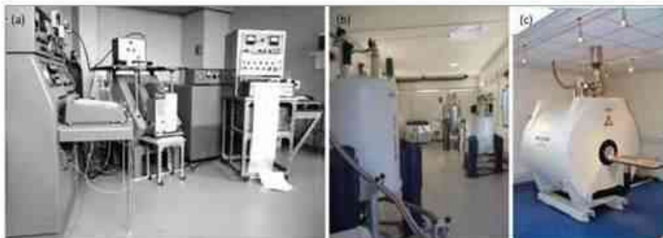
Fig. 2 : Résonance magnétique nucléaire : (a) 1969, spectromètre de RMN 90 MHz, (b) 2017, plateforme RMN avec Spectromètres 400 MHz (BRUKER 400 MHz), 600 MHz (VARIAN INOVA 600 MHz) et 700 MHz (BRUKER 700 MHz), (c) 2017, spectromètre d'imagerie magnétique RM à aimant horizontal de 9,4 Tesla.
