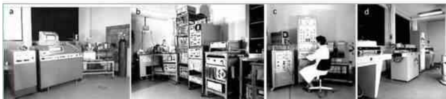
Fig. 1 : Instrumentation : (a) spectromètre de dichroïsme circulaire ; (b) spectrofluorimètre permettant des mesures de fluorescence impulsionnelle ; (c) spectromètre de résonance paramagnétique électronique ; (d) diffractomètre RX.
