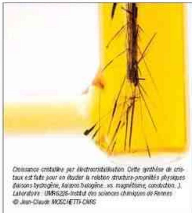
*Croissance cristalline par électrocristallisation. Cette synthèse de cristaux est faite pour en étudier la relation structure-propriétés physiques (viscosité hétérogène, liaison halogène... vs. magnétisme, conduction...).
