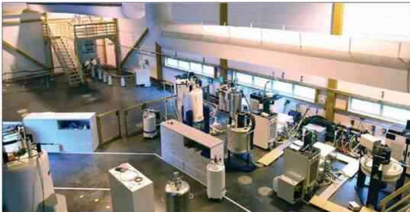
Installations RMN à l'ISA UMR 5260 CNRS/Université de Lyon/ENS Lyon, membre de l'IR-RMN-THC FR3501 CNRS. Au fond le 1000 MHz installé en 2005, et aujourd'hui encore le plus puissant spectromètre RMN haut champ. ©ISA – Anne Lesage
