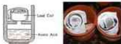
a. Schéma des étapes de la synthèse du blanc de plomb
