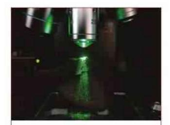
Du cheebon analysé par spectrumètrie Bamarc on y voit l'objectif du microscope et le faiceaux loser vest frappoint le charbon de boés (l'effet Bamari est un phinomène de diffición inflantique de ce faiceaux loser par l'échant Ban).
