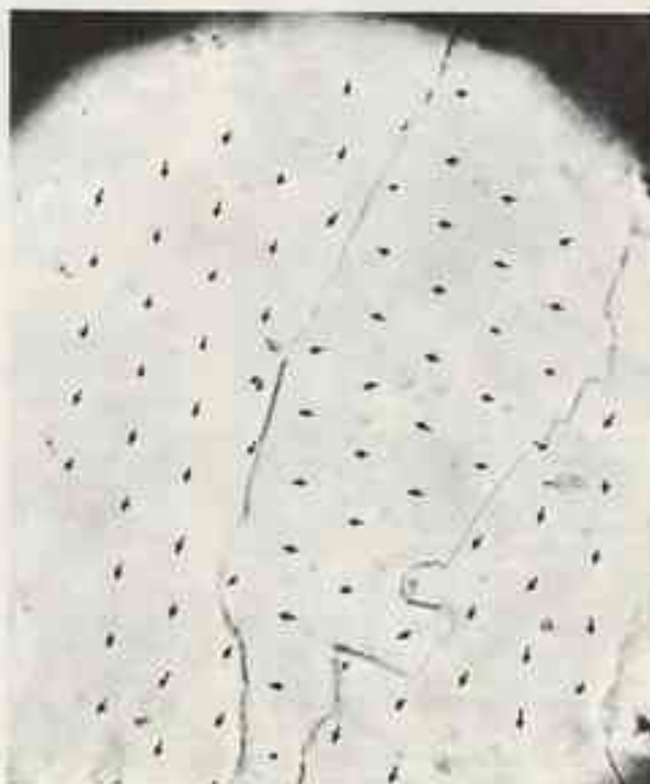
b) On constate que la déviation des images dépend de la zone choisie, et en particulier que les lignes introduisent des discontinuités dans cette déviation.
