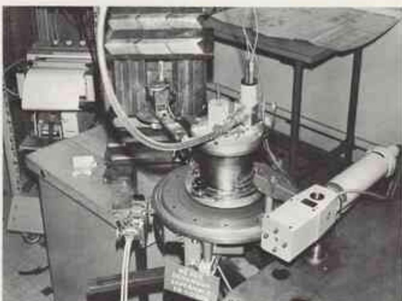
Vue du montage utilisé : à droite le tube à Rayons X ; au centre le goniomètre supportant la chambre à vide qui soutient le cristal, et à gauche, abritant le compteur, le châssis de plomb à l'entrée duquel se trouve le monochromateur.
