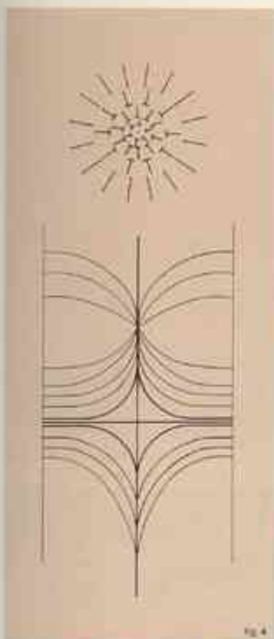
Fig. 4. Coupe transversale a) et longitudinale b) d'une dislocation dièdre sans singularité de cœur. On a figuré sur la coupe longitudinale deux points singuliers possibles.
