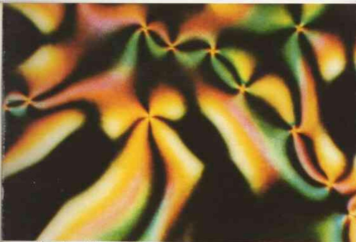
I. Structure à noyaux (Schlieren texture) dans une couche mince nématique vue entre polariseurs croisés. (Photo de C. Williams).
