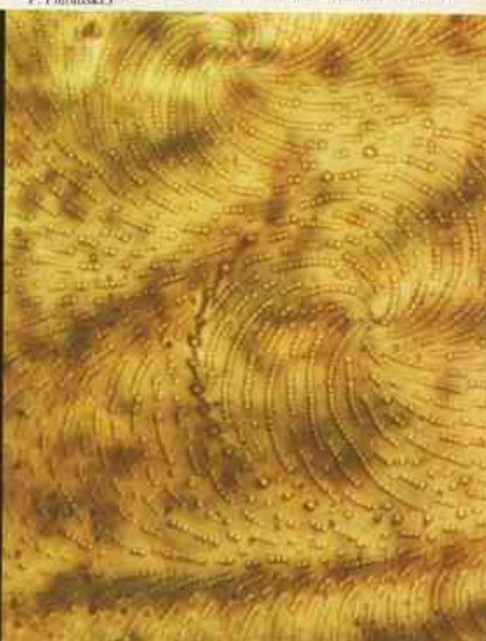
III. Décoration des distributions du directeur dans un plan perpendiculaire à une ligne. Les lignes de force sont visualisées par une émulsion de nématique dans un solvant organique. (Photo de P. Cladis et P. Pieranski.)
