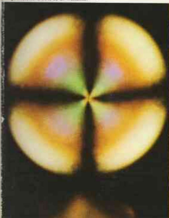
II. Gouttelettes de nématique germant dans la phase isotrope (nucleation) : on observe la présence d'une ligne dièdre au milieu de la gouttelette. (Photo de C. Williams).
