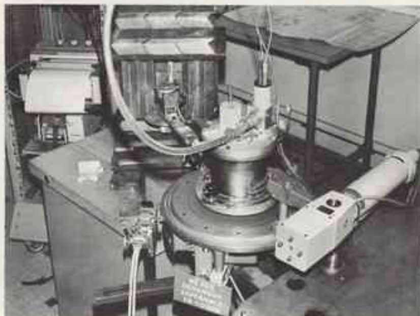
Vue du montage utilisé : à droite le tube à Rayons X; au centre le goniomètre supportant la chambre à vide qui contient le cristal, et à gauche, abritant le compteur, le châssis de plomb à l'entrée duquel se trouve le monochromateur.
