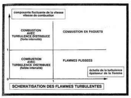
Fig. 3 - Structures des flammes dans un éconferment turbulent.
