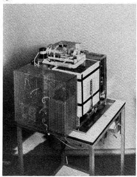
Pile ii combustible hydrogène air, d'une pulssance maximale de 1,3 kw.
