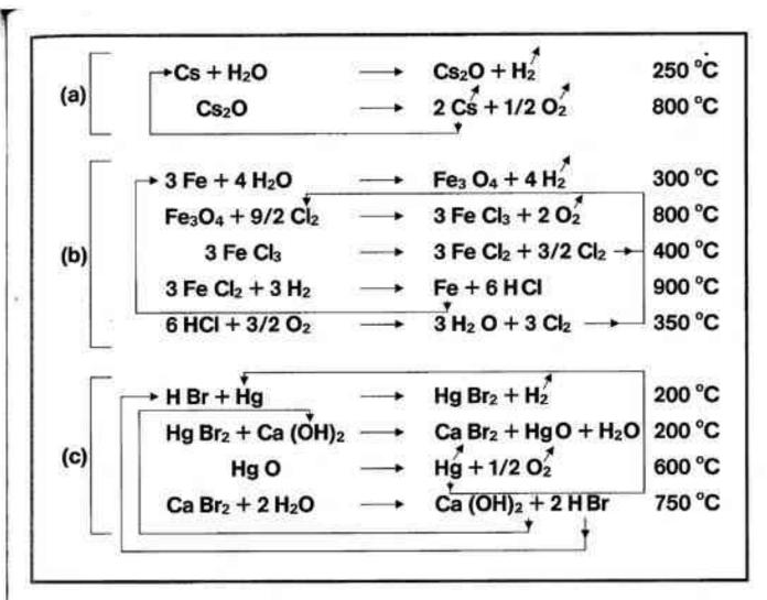
Fig. 1 - Exemples de cycles d'exydo-réduction possibles pour la fabrication d'hydrogène.
