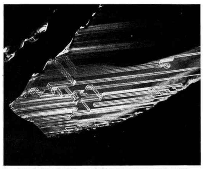
Laboraurira de chimie appliquire de l'état solicle. Microcraphie électronique montrant les défauts observés dans un monocristal d'alamine béta téchelle 3 cm = 2 000 A).
