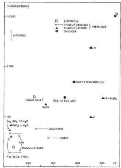
Fig. 8 - Comparaison de différents matériaux de stockage.
