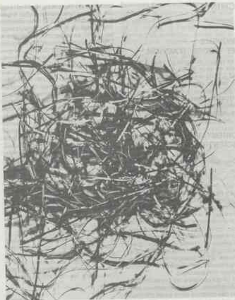
Enchevêtrement de rubans de verre métallique - Nouveaux solides, ils possèdent des propriétés macroscopiques intéressantes du point de vue technologique : ferromagnétisme, résistance à la corrosion, bonne tenue mécanique, passivité aux effets d'irradiation, etc... (LA 158 - Nancy).
