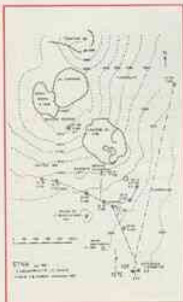
Figure 1 - Les cratères sommitaux de l'Etna et le réseau de télésurveillance sismique et potentiel implanté du sud au nord sur le cône central. La station de référence TDP (Torre del Filosofo) est également pourvue d'un géophone et d'un détecteur de conductivité. (D'après C. Aychambaut, ARGOS Newsletter n° 15, 1982).
