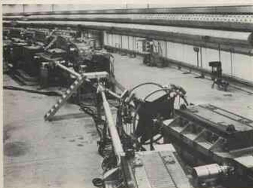
Zone d'intersection des anneaux de collision proton-proton de 28-GeV du CERN. On voit les deux anneaux dans lesquels circulent les protons en sens inverse. Ces rayons sont dirigés dans la zone d'intersection, courbés et passant dans des électro-aimants déposant sur un cercle de 200 mètres de diamètre. Les deux paires d'anneaux placées le long des trajets sont des compteurs détecteurs servant à enregistrer les interactions des protons.
