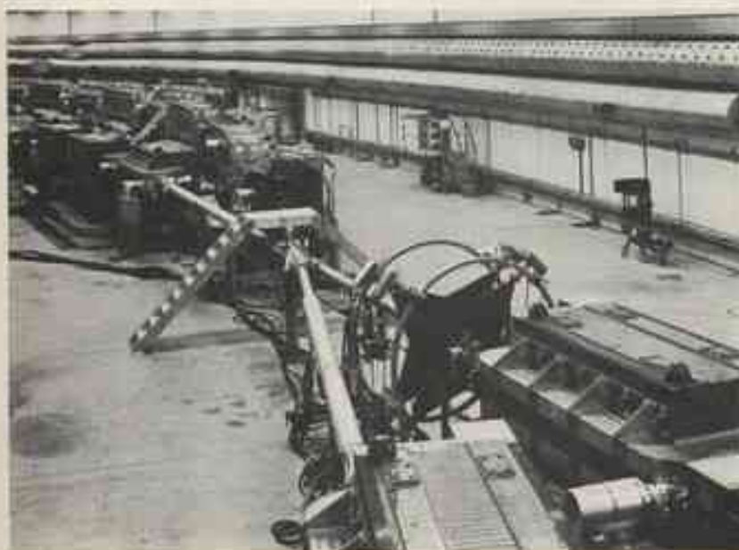
Zone d'intersection des anneaux de collision protons de 28 GeV du CERN. On voit les deux anneaux dans lesquels circulent les protons et leur inverse. Ces rayons sont dirigés dans la zone d'intersection, couverts et passant dans des électro-aimants disposés sur un cercle de 266 mètres de diamètre. Les deux paires d'électro-aimants le long des tunnels sont des compteurs, détecteurs servant à enregistrer les interactions des protons.
