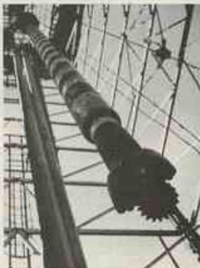
Vue à l'extrémité d'une turbine de forage, un trépan neuf va être descendu dans le puits.
