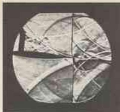
Interaction d'une onde de choc plane et d'un tourbillon isolé au moyen d'une onde acoustique (Centre de recherches physiques).
