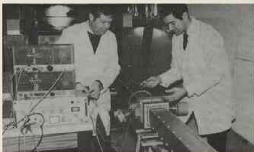
Centre de recherches physiques — Service d'acoustique générale : *L'anti-bruit électroacoustique* — au cours de son expérimentation sur cube à ondes progressives.
