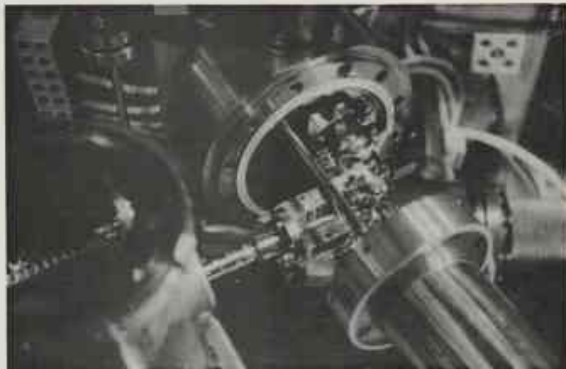
Sources d'ions destinées à l'analyse à partir des solides, en spectrométrie de masse.
