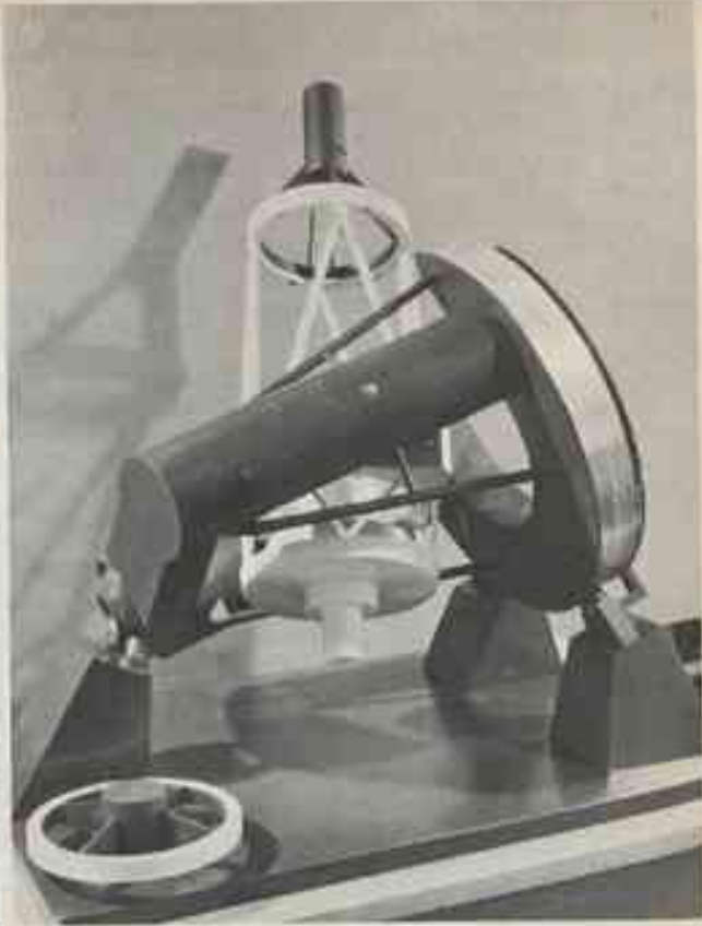
(Fig. b) Nive Nord. Le tube du type « Serrurier » pèse environ 30 t. La couronne est répétée avec l'anneau de site permettant l'observation en Cassegrain (Fig. a) et avec celui portant la cage primaire où sont également vissés les miroirs de renvoi pour le foyer final (Fig. 1).
