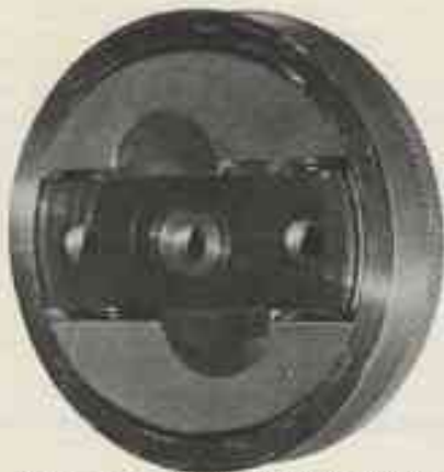
Un inventeur a mis au point un mécanisme à joints frottants et supports auto-orientables qui constitue un accomplissement à sens unique pourvu être interposé entre deux organes tournant l'un par rapport à l'autre. Une version réversible dont la réversibilité est commandée à volonté permet d'inverser les deux sens d'entraînement et de roue libre. Une première licence a déjà été conclue. (Dossier d'inventeur indépendant).
