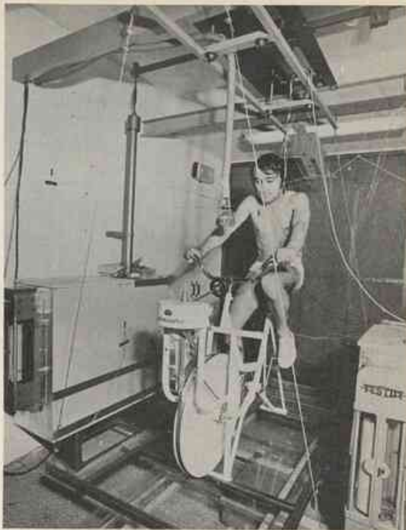
Fig. 2. Aménagement intérieur de la chambre climatique à hautes performances pour l'étude de la thermorégulation au cours de l'exercice musculaire : le sujet effectue des exercices à puissance variable sur un cyclergomètre copiant lui-même sur le plateau d'une balance enregistreuse (enregistreur graphique de gauche) ; cette balance permet la mesure continue de la partie de poids du sujet ; sous le plateau en caoutchouc de la balance se trouve un tac de même surface recueillant la sueur déperlant du sujet, sueur dont le poids est enregistré par une deuxième balance enregistreuse graphique de droite. Le sujet est muni de deux thermocouples calés dans l'artère fémorale et d'électrodes de surface de l'électrocardiogramme. Plusieurs sondes thermomètres et hygromètres permettent l'enregistrement des conditions thermohygrométriques en divers points de la chambre.
