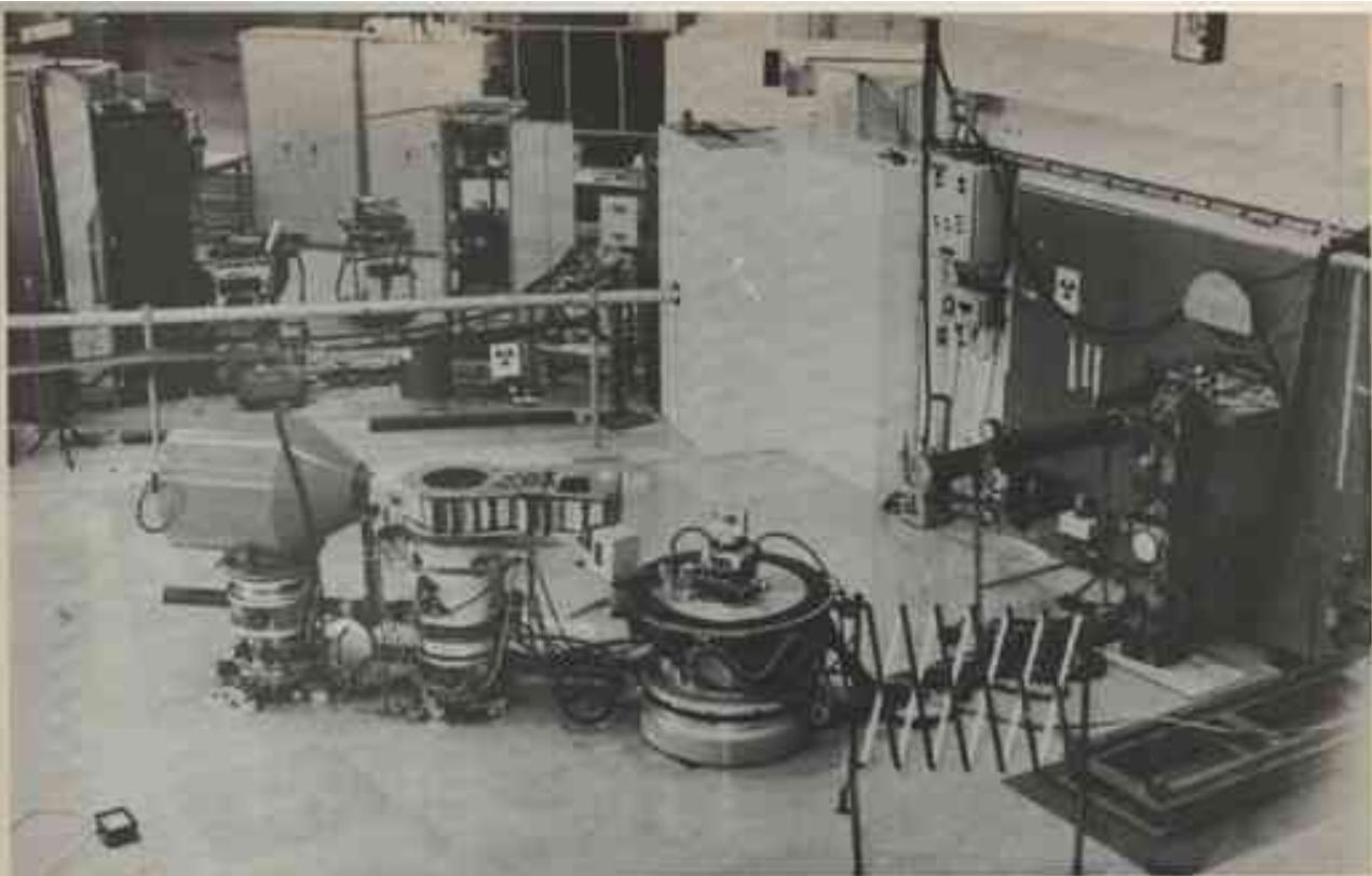
Fig. 1 - Un spectromètre à 3 axes à la sortie d'un réacteur nucléaire. La table du monocristallier est mise à l'intérieur de la protection héliogaine.
