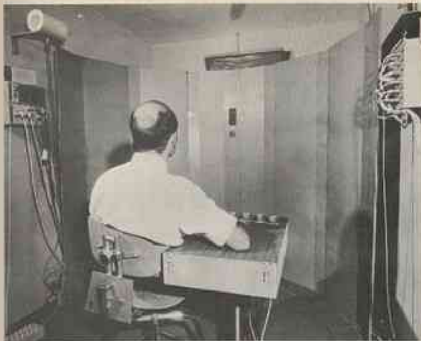
Fig. 7 - Cellule de performances psychomotrices : le sujet repose sur un élévateur pivot et sa main droite aux commandes de signaux présentés sur le panneau qui lui fait face, selon des programmes de choix sériel ou de mémorisation sérielle.
